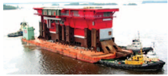
Рис. 4. Морская транспортировка вспомогательного модуля с «Выборского судостроительного завода» на МЛСП «Приразломная»
