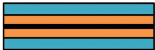
Рис. 1. Варианты композиционной обшивки: а – исходный вариант; б – демпфированный вариант
