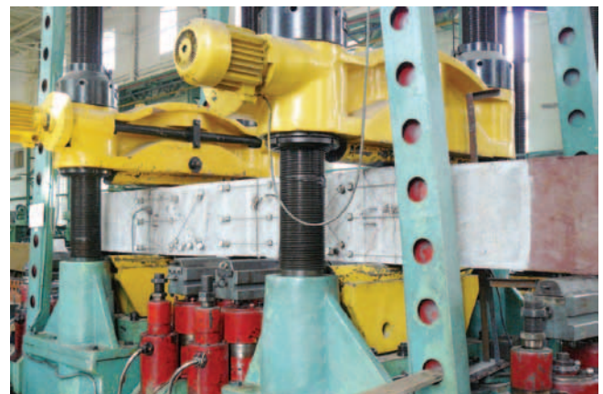
Рис. 7. Общий вид опытной сталебетонной балки с внешним листовым армированием на испытательной машине
