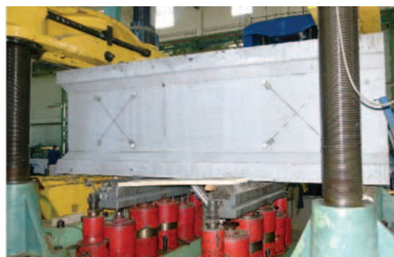
Рис. 3. Испытания опытной конструкции в виде балки-стенки из бетона с АКП на поперечный изгиб
