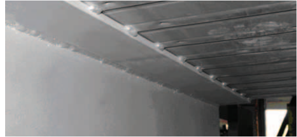
Рис. 9. Опорное сечение образца. Показан узел крепления панели к палубе
