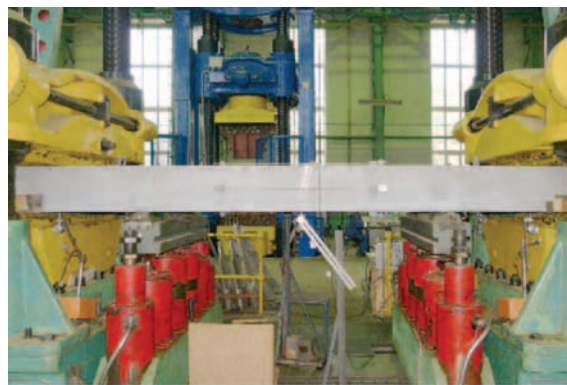
Рис. 2. Испытания опытной конструкции в виде удлиненной плиты из бетона с АКП на поперечный изгиб
