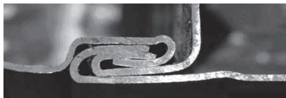
Рис. 15. Вид «шва» в промежутке между «заклепками»
