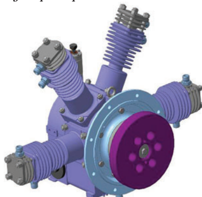
Рис. 8. 3D-модель компрессорной части четырехрядного бустера
