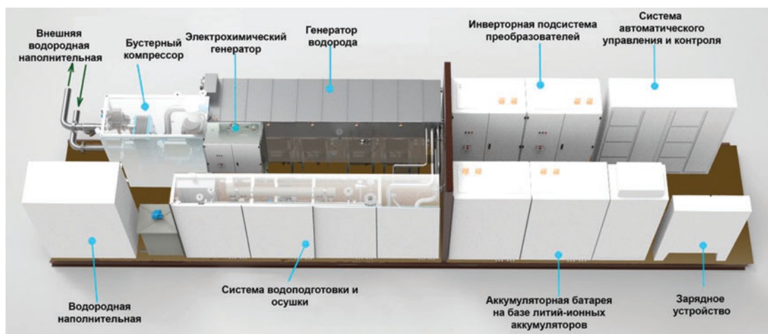
Рис. 1. Модель гибридного сетевого накопителя, реализуемого ООО «Судпромкомплект»
