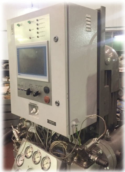
Рис. 6. Прибор управления ПУ SKA60/200 на компрессоре
