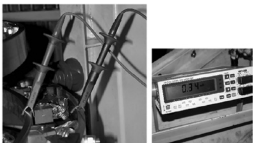
Рис. 3. Измерение сопротивления между контактными кольцами и наружной шиной
