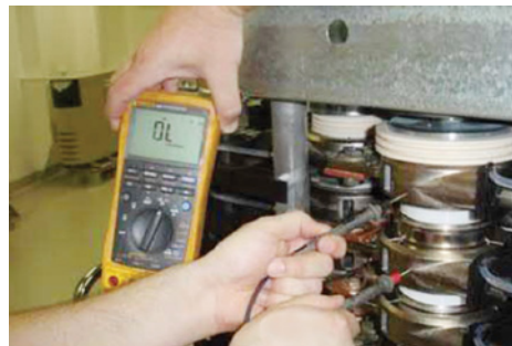
Рис. 20. Измерение падения напряжения на диоде фазного модуля: а – в проводящую сторону, б – в непроводящую сторону
