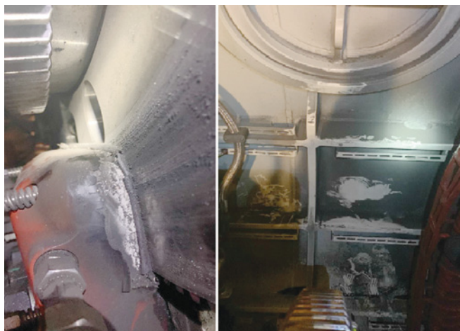
Рис. 9. Последствия повреждения тормозного механизма
