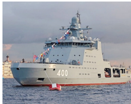
Рис. 9. Патрульный корабль ледового класса Arc7 водоизмещением около 8000 т с высоковольтной системой электродвижения
