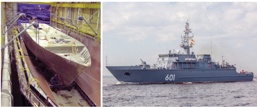
Рис. 5. Корабль ПМО пр. 12700 из полимерных композитных материалов
