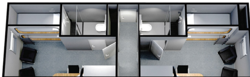
Рис. 3. Компоновка жилого контейнера
