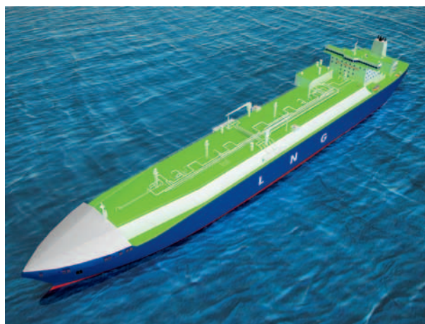
Проектный внешний вид газозовоза грузовой вместимостью 215 тыс. м 3 с складными призматическими танками типа SPB
