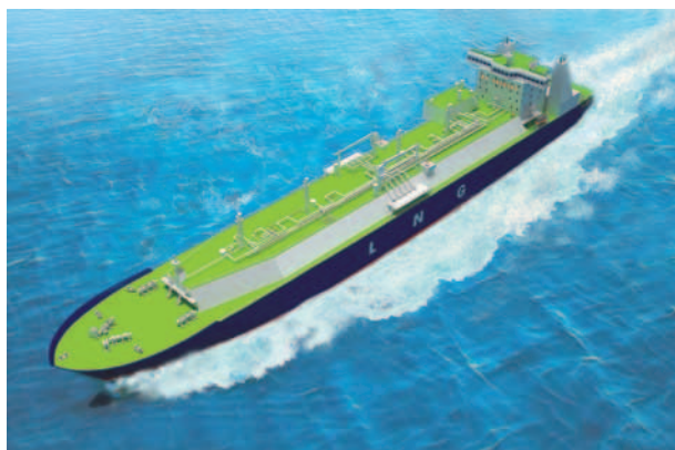
Газозовоз грузовой вместимостью около 80 тыс. м 3 с мембранными грузовыми танками NO96
