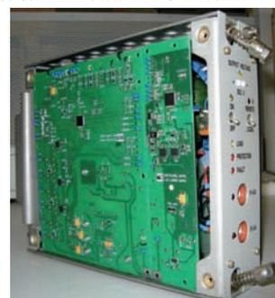
Рис. 3. Внешний вид модуля-преобразователя со снятой крышкой
