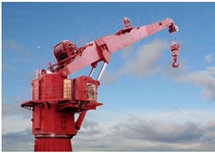
**Кран грузовой электрогидравлический грузоподъемностью 80 т**
