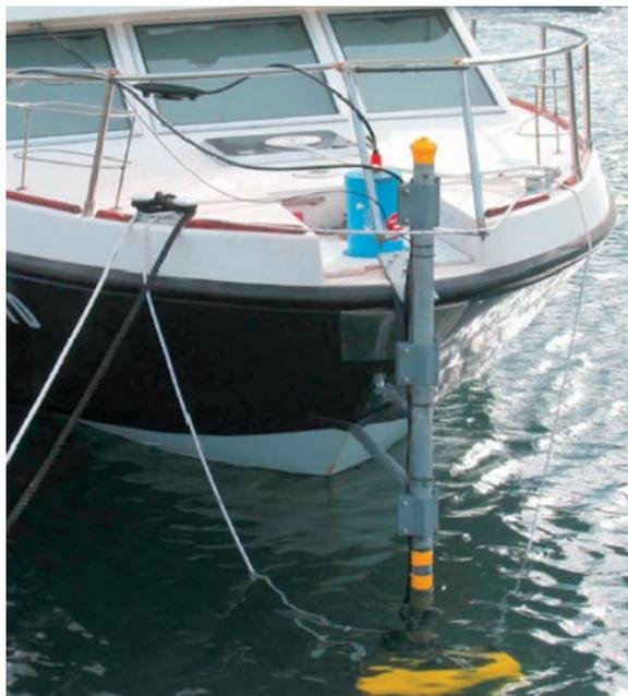
Рис. 1. Пример установки ГАС на носовой штанге
