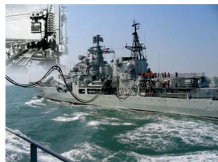
**Устройство передачи сухих и жидких грузов в море на ходу траверзным способом**
