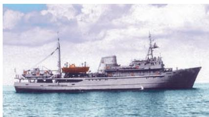
*Судно безобмоточного размагничивания*
