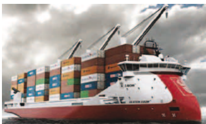
Рис. 4. Фидерный контейнеровоз с носовым расположением рубки
