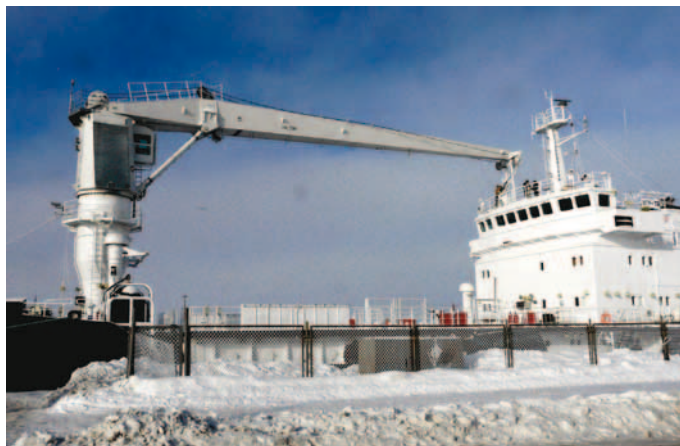
Рис. 1. Палубный полноповоротный стреловой гидравлический кран грузоподъемностью 20 т
