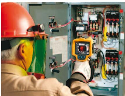
Рис. 1. Тепловизионная диагностика оборудования внутри электрического щита
