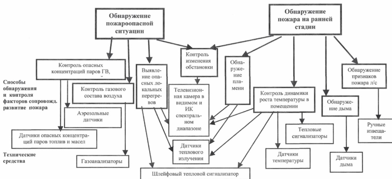
Рис. 1. К определению номенклатуры извещателей для информационного обеспечения управлением пожаробезопасностью корабля в зависимости от пожароопасных факторов в корабельном отсеке
