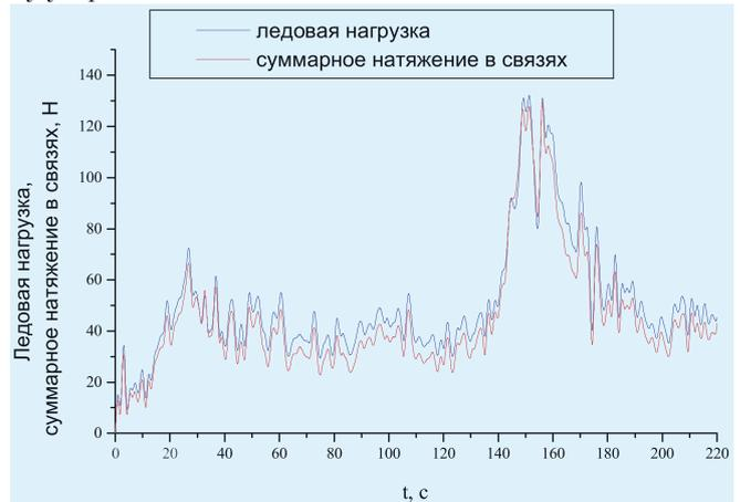
Рис. 2. Ледовая нагрузка и продольная проекция суммарного натяжения в связях при взаимодействии модели с торосистыми образованиями
