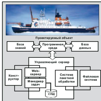
Рис. 4. Модульная структура программного комплекса
