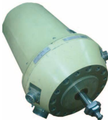
Рис. 5. Электропривод в сборе с двухступенчатым редуктором
