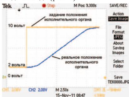
Рис. 4. Отработка положения исполнительного органа при задании положения от 0 до 100%
