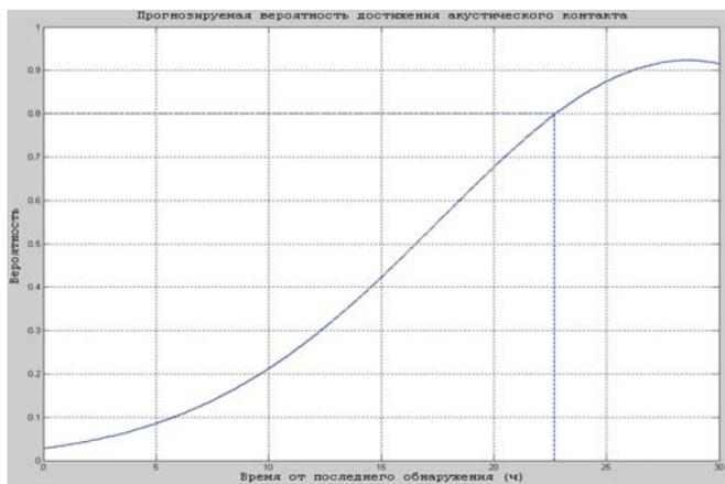
Рис. 2. Изменение прогнозируемой вероятности достижения акустического контакта полистатической системой
