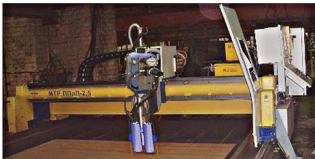
Рис. 3. Промышленный каплеструйный принтер портального типа
