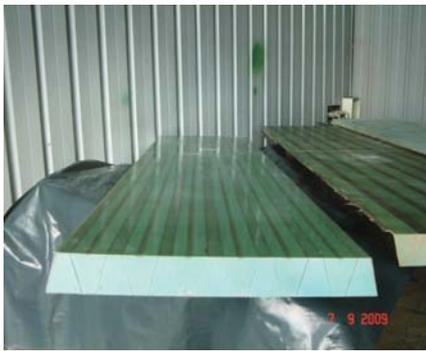
Рис. 8. Типовые панели среднего слоя с гофрированным элементом, изготовленные RTM-методом
