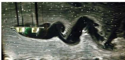
Рис. 9. Вихревой след за Волгоградским мостом. Визуализация водородными пузырьками,  $Re = 9000$
