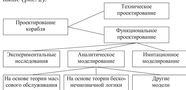
Рис. 2. Методы функционального проектирования
