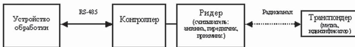
Рис. 1. Состав системы радиочастотной идентификации
