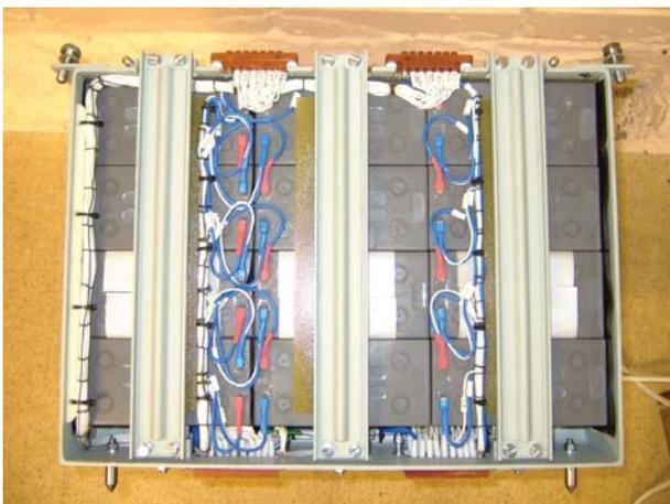
Рис. 1. Аккумуляторный отсек АБП со свинцовыми герметизированными АБ: *вверху слева – отсек выдвинут из АБП; справа – в штатном положении; внизу – вынут из АБП (вид сверху)*
