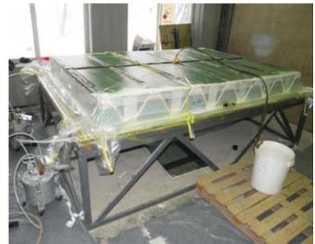
Рис. 11. Изготовление макета трехслойного перекрытия с гофрированным средним слоем методом инфузии
