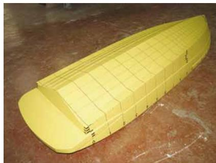
Рис. 3. Модель 60-футовой моторной яхты
