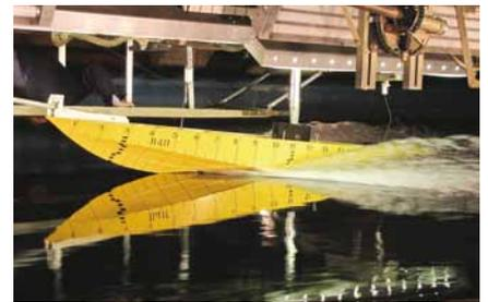
Рис. 5. Испытания модели катера
