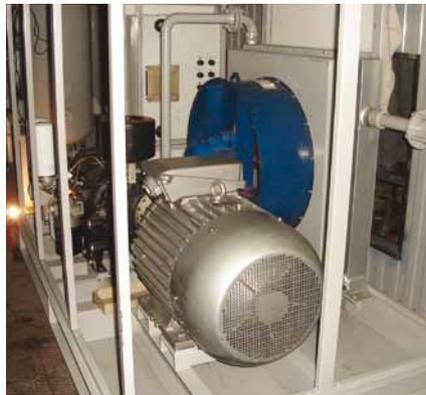
Модульные воздушные компрессорные станции типа БВКС предназначены для размещения технологического оборудования и подачи сжатого воздуха в качестве барьерного, в концевые лабиринтные сухие газовые уплотнения (СГУ) нагнетателя газоперекачивающего агрегата (ГПА), для запирания утечек газа проходящих через первичные уплотнения ротора нагнетателя и для других целей.
