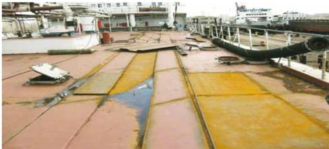
Рис. 4. Накладные полосы по палубе теплохода пр. 1577 типа «Волгонефть» (нефтеналивное судно на слипе в период ремонта)
