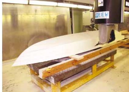
Рис. 2. Изготовление модели катера
