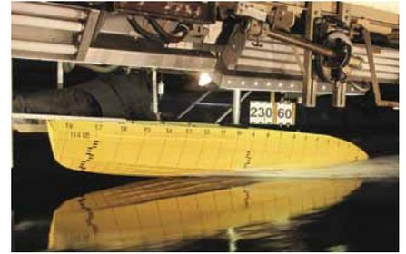
Рис. 4. Испытания модели 60-футовой моторной яхты. Скорость – 60 уз
