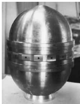
Рис. 13. Прочный корпус из титанового сплава
