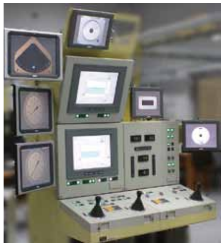
Рис. 2. Внешний вид ИПУ СУМ с «навесными» панельными компьютерами
