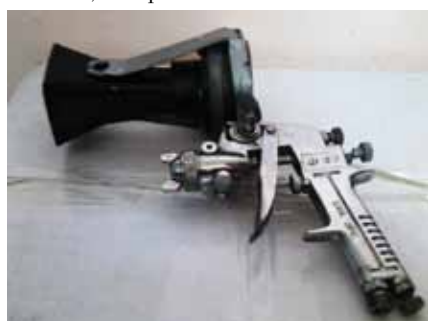
Рис. 3. Внешний вид краскопульта с малогабаритным акустическим излучателем
