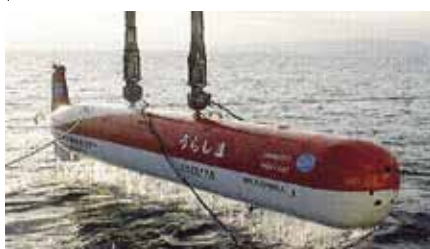
Рис. 1. АНПА «Urashima» (Япония) водоизмещением 10 т
