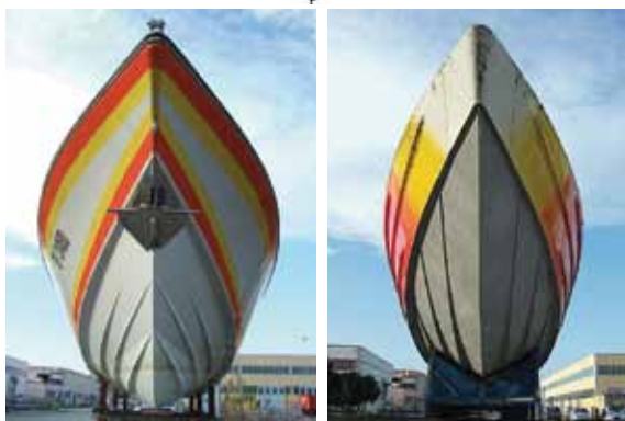
Рис. 4. Расположение продольных реданов на 38-футовом катере (слева) и на 40-футовом катере «Собра» (справа) конструкции Дональда Шеда, Великобритания
