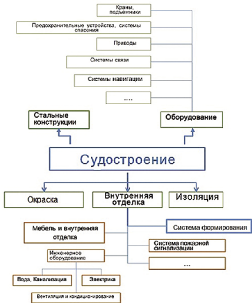
Рис. 1. Положение системы формирования помещений в судостроении
