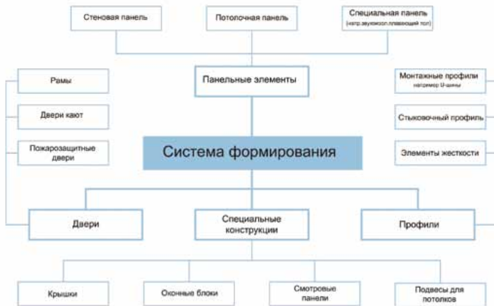
Рис. 2. Основные компоненты системы формирования помещений, которые отнесены к отдельным категориям
