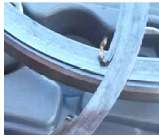
Рис. 13. Коробление уплотнительных прокладок упорного подшипника привода Арнесона
