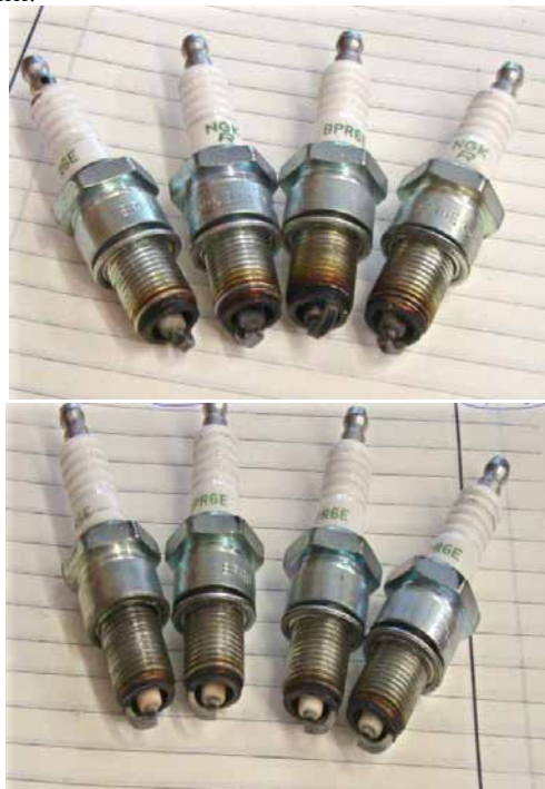
Рис. 4. Свечи зажигания контрольного двигателя (слева) и испытуемого двигателя (справа) после ресурсных испытаний.
