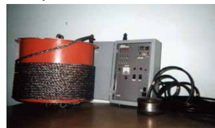
Рис. 1. Внешний вид одной из модификаций проводниковой системы «ГАРД» (запасы линия и троса размещены вокруг подводного модуля)
