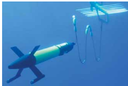
Рис. 13. Волновой глайдер с эхолотом во время испытаний на Гавайях летом 2012 г.
