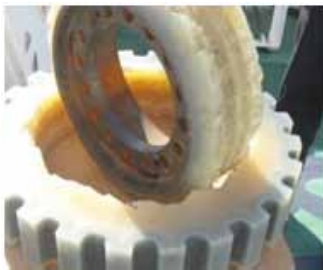
Рис. 12. Обрыв эластичной муфты
