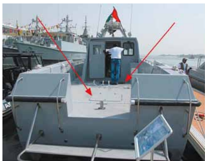
Рис. 3. Катер пр. SM16 на выставке NAVDEX2013 (проект «AMD», сертификация IRS). Хорошо видны люки МО, выполненные без комингсов. Наличие комингсов на судах подобного размера приводит к риску травматизма и невозможно эффективно использовать площадь палубы
