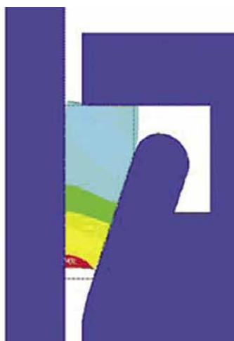
Рис. 5. Распределение суммарных перемещений в резиновом уплотнении. Максимальное (красный цвет) перемещение – 0,994 \text{ мм}
