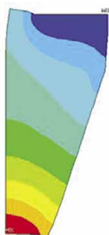
Рис. 6. Распределение продольных перемещений в резиновом уплотнении. Максимальное (красный цвет) перемещение – 0,969 \text{ мм}
