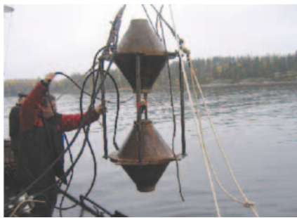
Рис. 4. Внешний вид системы из двух гидроакустических излучателей
