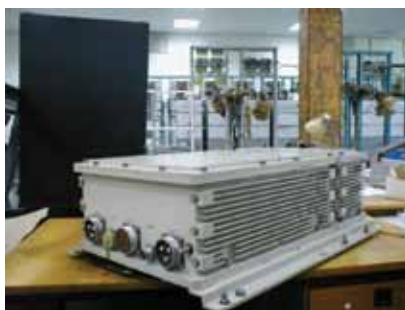
Рис. 2. Корабельный автоматический переключатель сетей ~3×220 В, 400 Гц во время испытаний на электротехническом стенде НПО «Аврора»
