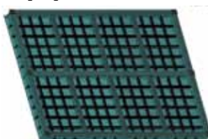
Рис. 10. Конечно-элементная модель палубы между опорными колоннами с перекрытием типа 2
