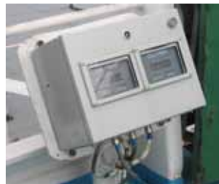
Приборы ПИ1 на крыльях мостика
