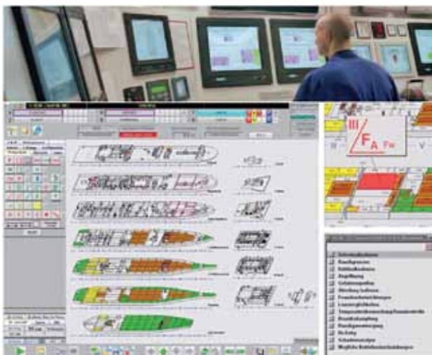
Рис. 1. Система контроля боевых повреждения компании «Siemens». Используется на фрегате типа 125
