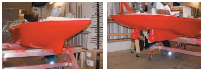
Рис. 5. Модель, испытанная в ледовом бассейне фирмы Aker Arctic (вид с носа и с кормы)
