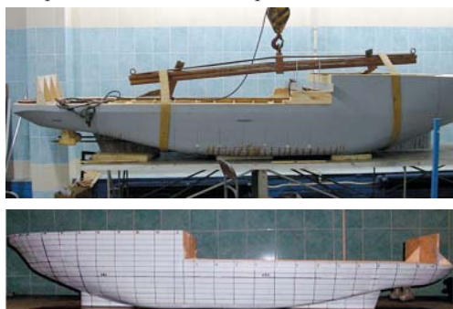
Рис. 11. Общий вид большой модели для буксировочных и самоходных испытаний и малой модели для мореходных испытаний
