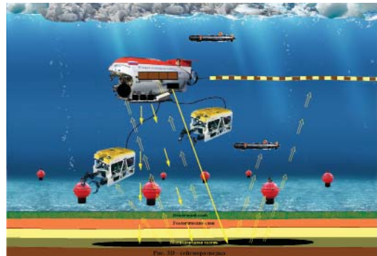
Рис 2. Принцип реализации модернизированной технологии 3D-сейсморазведки с использованием подводного геофизического судна
