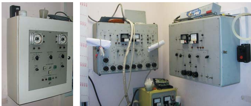
Рис. 3. Аппаратура для имитации отклонений напряжения и частоты в агрегатной спецтоков
