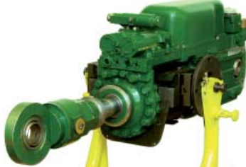
Рулевой привод 6Д-4100-000 для ракетного двигателя РД-0120 (КБХА), который входил в комплектацию II ступени (блок Ц) ракеты-носителя «Энергия»
