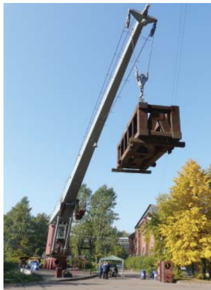
Рис. 1. Кран судовой электрогидравлический специальный грузоподъемностью 20 т
