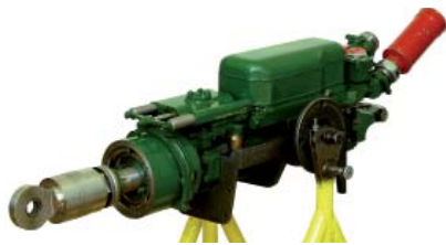
Рулевой привод 2Д-4100-000 для ракетного двигателя РД-170 (НПО «Энергомаш»), который входил в комплектацию I ступени (блок А) ракеты-носителя «Энергия»
