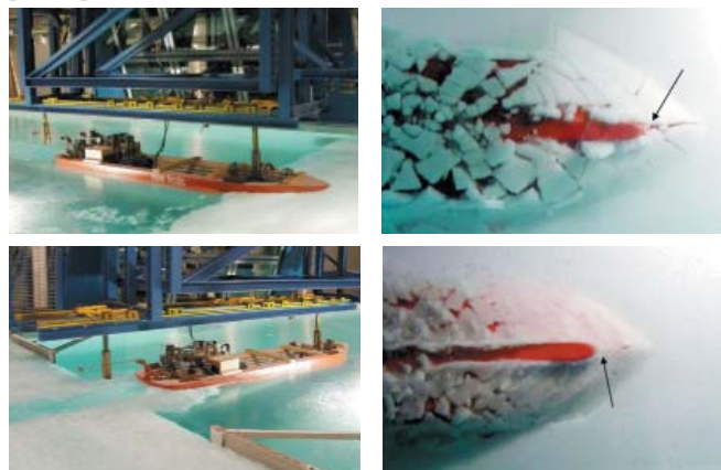
Рис. 6. Фрагменты видеозаписей испытаний при толщине льда 0,50 и 1,00 м
