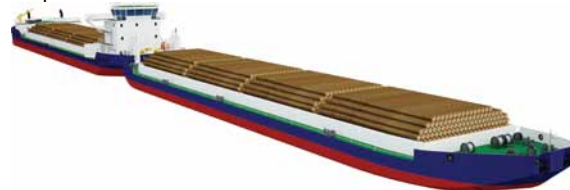
Рис. 8. Пример современного ББС для р. Лена. Сухогруз-толкач пр. RD63, баржа пр. RDB21
