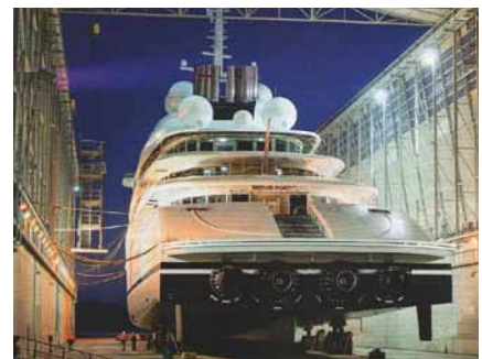
Круизная яхта «Azzam» в доке германской верфи «Lürssen Shipyard» с установленными водометными движителями
