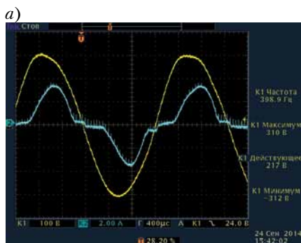
Рис. 4. форма тока и напряжения с применением «коррекции формы»: а – однофазный преобразователь нагрузка 1; б – трехфазный преобразователь нагрузка 1
