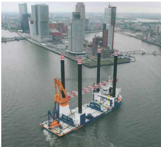
Рис. 9. Судно «Aeolus», построенное германскими верфями «Sietas» в Гамбурге и «Lloyd Werft» в Бременхафене, предназначенное для монтажа и обслуживания морских ветрогенераторных платформ
