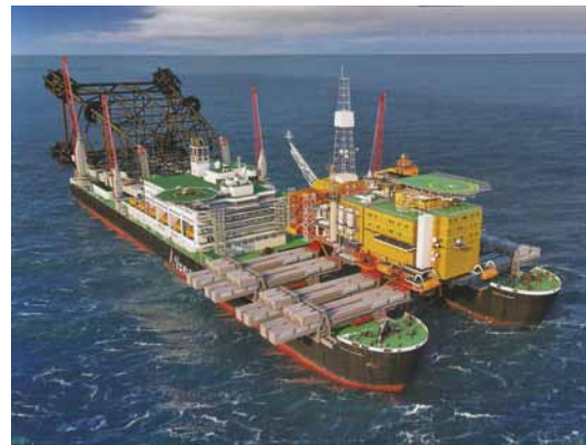
Рис. 11. Монтажное судно-платформа «Pieter Schelte»
