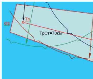
Рис. 1. Необходимая высота возвышения приемопередающих антенн РЛС «Кама-Н» над уровнем моря для обеспечения дальности сопровождения полета ракеты минимум двумя станциями на безопасном удалении от береговой черты
