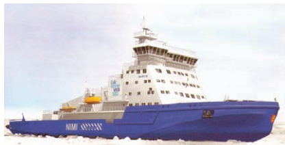
Рис. 15. Ледокол с силовой установкой на сжиженном газе
