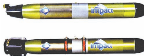
324-мм универсальная по носителям электрическая противолодочная торпеда Eurotorp MU90 «Impact» в авиационном (вверху) и корабельном (внизу) исполнении
