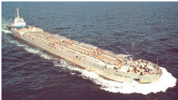
Рис. 11. Буксирно-баржевый состав грузоподъемностью 4630 т
