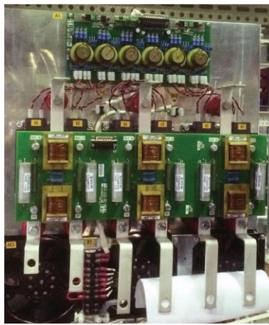
Рис. 4. Статический ключ электронного переключающего устройства АУБЭС
