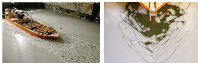
Бассейновые испытания модели ледокола
