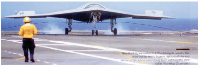
Рис. 9. Посадка БПЛА X-47В на палубу авианосца «Гарри Трумэн». Хорошо виден тормозной трос, который гасит скорость БПЛА
