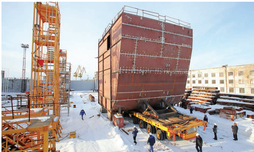
Вывоз блока ледокола «Владивосток» пр. 21900М из цеха на стпель
