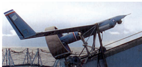
Рис. 4. Запуск БПЛА Scaneagle с борта фрегата «Садерленд» ВМС Великобритании. Хорошо видны вертикальные оконечности крыльев
