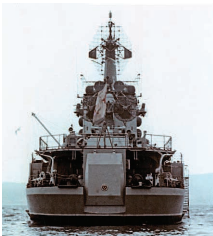
Рис. 4. БПК «Николаев» пр. 1134Б. Кормовая крышка буксируемой ГАС переменной глубины «Вега»
