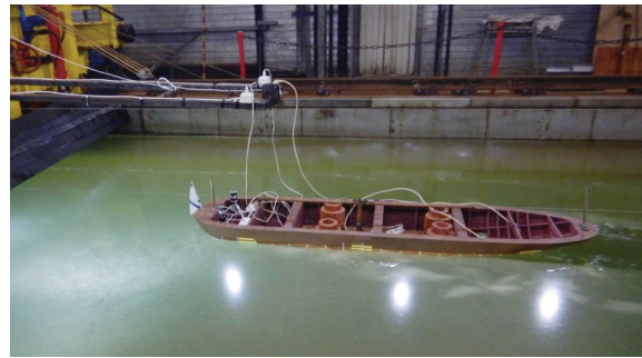
Рис. 6. Общий вид ледового бассейна ААНИИ (а) и самоходные испытания модели ледокола пр. 21180М (б)
