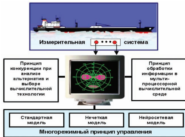
Рис. 1. Программный комплекс контроля динамики судна в ледовых условиях
