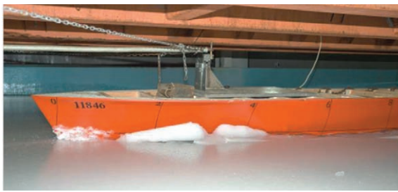
Рис. 4. Испытание модели судна пр. 22120 на ледопроеходимость
