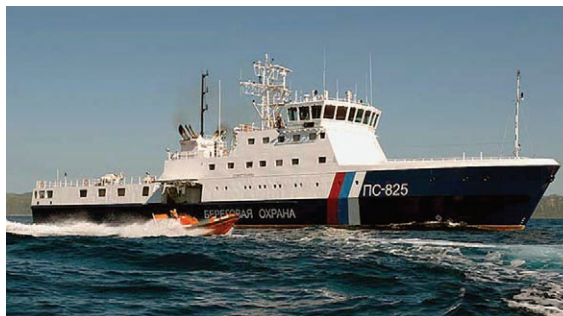
Рис. 3. Патрульное судно ледового класса ПС-825 пр. 22120
