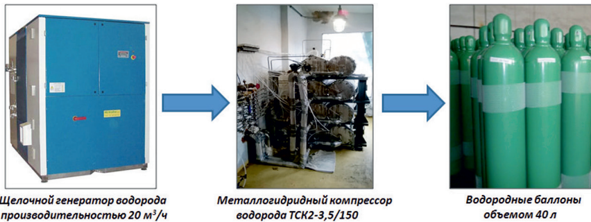
Рис. 8. Опытно-экспериментальная линия производства водорода
