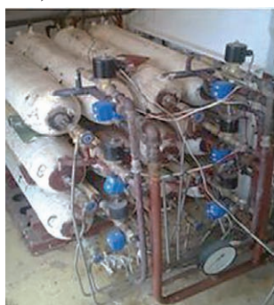
Рис. 4. Общий вид (а) и схема (б) компрессора ТСК1-3,5/150
