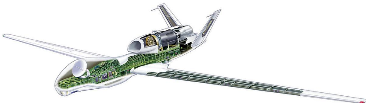
*Рис.2. БПЛА RQ-4 «Глоубал Хок» в разрезе. Хорошо видна антенна связи через ИСЗ, расположенная в носовой части аппарата.*
