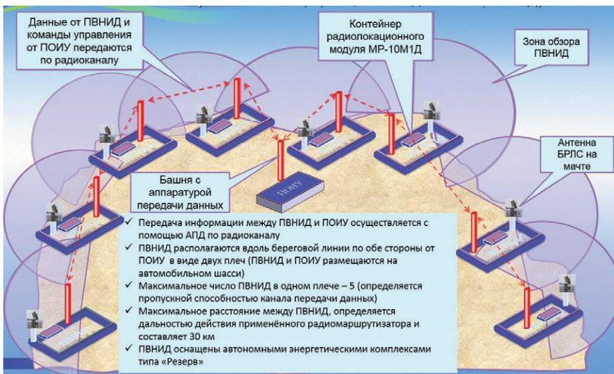
Рис. 7. Структура и расположение составных частей РЛС с ПВНИД
