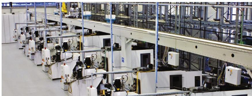
*Гибкая производственная система Fastems*
