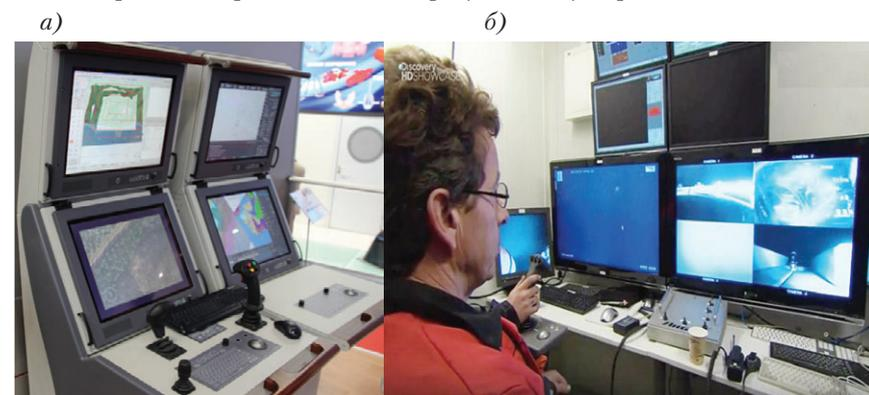
Рис. 8. АРМ пилота БПЛА (а) и пост управления и контроля ТНПА (б)
