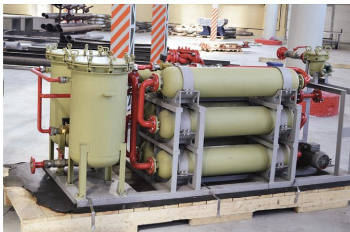
**Установка очистки сточных вод, УОСВ, 15 м<sup>3</sup>/ч**
