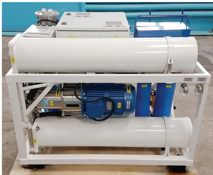
**Установка опреснения морской воды, УОМВ, 5 м<sup>3</sup>/ч**
