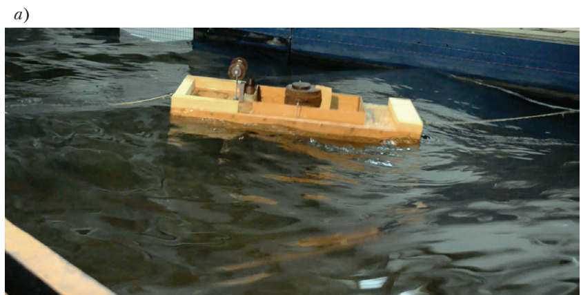
Рис. 7. Судно в полном грузу на регулярном волнении с \lambda/L = 2,0 , крутизна волн h = 1/21,2 ; курсовой угол к волнению 90^\circ
