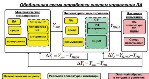
Рис. 1. Обобщенная схема отработки систем управления ЛА
