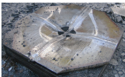
Рис. 6. Образец для определения работоспособности сварных соединений при малоцикловых нагрузках (а) и образец для определения динамической прочности сварных соединений (б)
