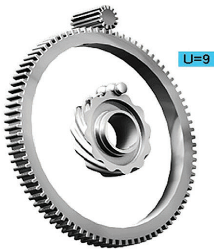
Рис. 3. Размеры редуктора с эвольвентным и ЭЦ зацеплением с одинаковыми передаточным отношением и крутящим моментом
