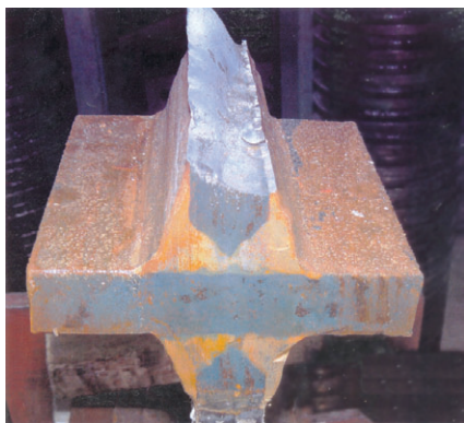
Рис. 7. Волокнистый излом сварного шва, выполненного проволокой ПП-А22/9
