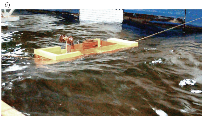
Рис. 7. Судно в полном грузу на регулярном волнении с \lambda/L = 2,0 , крутизна волн h = 1/21,2 ; курсовой угол к волнению 90^\circ
