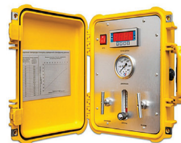
Рис. 7. Система контроля влаги в сжатом воздухе СИВ
