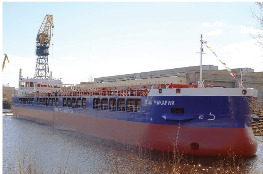
Рис. 2. Сверхполный корпус судна пр. RSD59 после спуска
