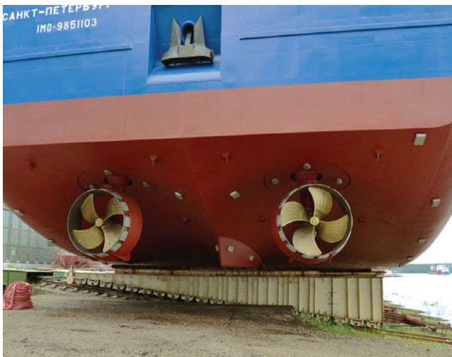
Рис. 9. Полнооборотные винторулевые колонки на судне пр. RSD59
