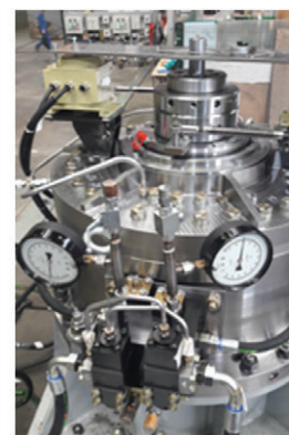
Рис. 4. Роторная рулевая машина, разработанная специалистами ЗАО «ЦНИИ СМ»
