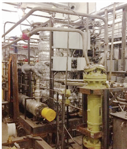
Воздухонезависимая энергетическая установка, созданная АО «ЦКБ МТ «Рубин» на базе электрохимических генераторов
