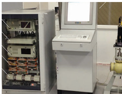
Имитационный отладочный комплекс с разрабатываемой системой автоматического управления (САУ)
