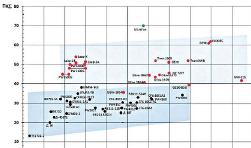
Рис. 8. Степень повышения воздуха в компрессоре авиационных ГТД
