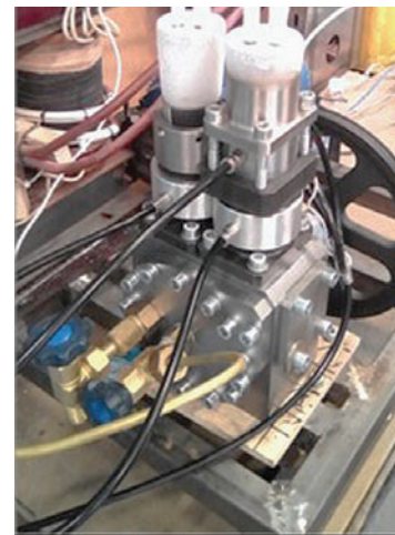
Рис. 4. Обкатка ТМ в режиме холодильной машины
