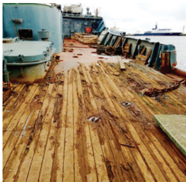
Рис. 1. Поврежденные деревянные настилы вспомогательных судов ВМФ
