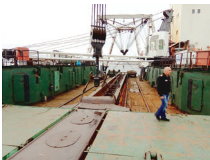
Рис. 5. Деревянный настил на верхней палубе КИЛ-31
