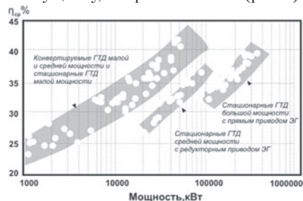
Рис. 2. Значения эффективного КПД \eta_e наземных и конвертируемых ГТД различных мощностей. Условия ISO 2314 (ГОСТ 20440–75)
