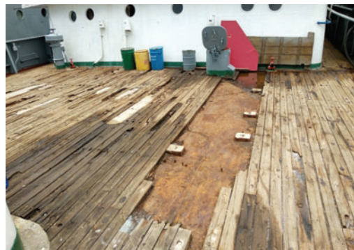
Рис. 1. Поврежденные деревянные настилы вспомогательных судов ВМФ
