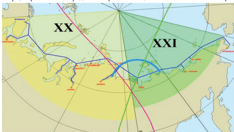
Рис. 6. Районы передачи ИБМ НАВАРЕА XX и XXI, северные границы зон действия спутников ИНМАРСАТ (фиолетовая и зеленая линии) и станции НАВТЕКС в порту Тикси (обозначена голубой дугой)
