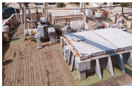
Рис. 2. Деревянные настилы на верхней палубе ГС «Донузлав»
