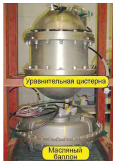
Рис. 5. Элементы системы управления плавучестью АНПА «Urashima»
