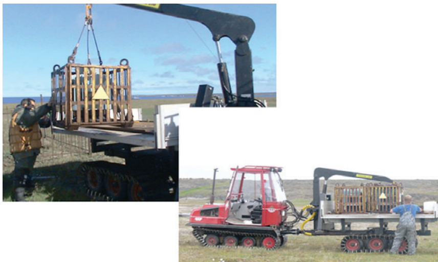
Рис. 7. Погрузка и вывоз РИТЭГ на специализированном мини-тракторе, выгружаемом на судовой барже с гидрографического судна непосредственно в районе работ
