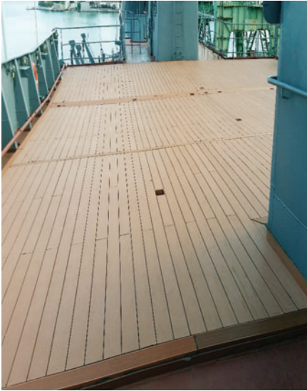
Рис. 7. Верхняя палуба УК «Перекоп» с покрытием террасной доски из ДПК
