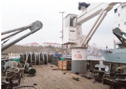
Рис. 4. Деревянный настил на грузовой палубе КС «Сетьунь»
