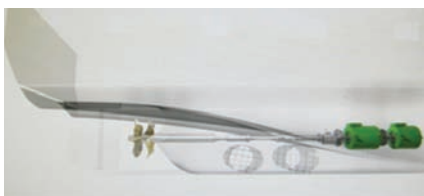
Рис. 7. Судно снабжения «Juanita» (длина наибольшая – 88,9 м, водоизмещение – 9056 т) и его движитель фирмы Scana Volda
