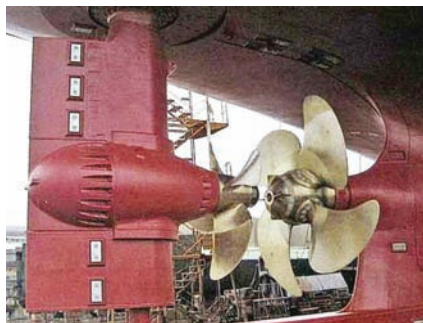
Рис. 8. Рыболовное судно «Nippon Maru» (длина наибольшая – 75,8 м, водоизмещение – 4300 т) и его гибридный движитель фирмы Kamote Propeller
