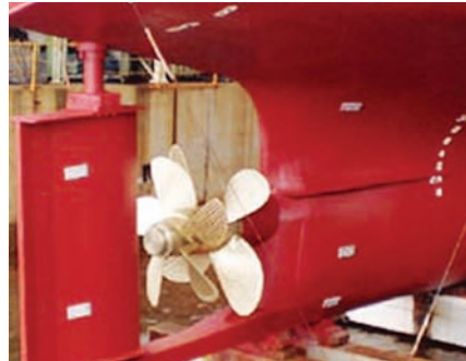
Рис. 4. СГВ пропульсивной установки типа IHI-CRP Electric Propulsion System [13]
