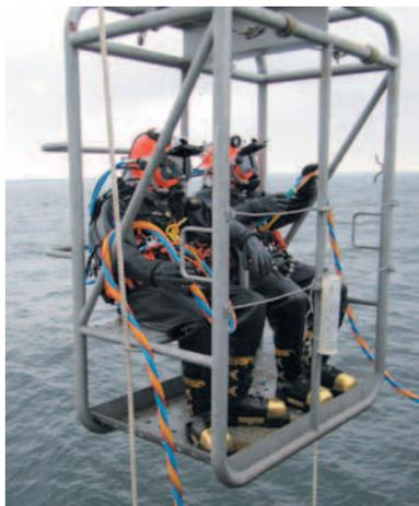
*Спуск водолазов в беседке в снаряжении СВУ-5-1*
