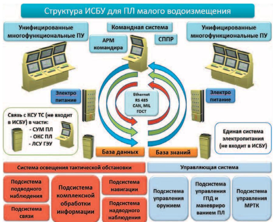
Рис. 1. Структура ИСБУ перспективной ПЛ малого водоизмещения
