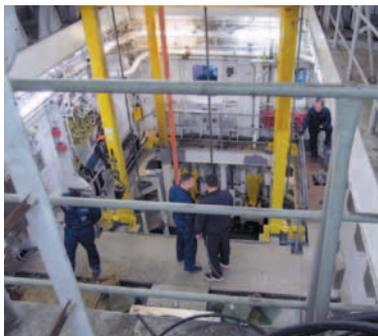
**Спускоподъемное устройство и шахта водолазного колокола**
