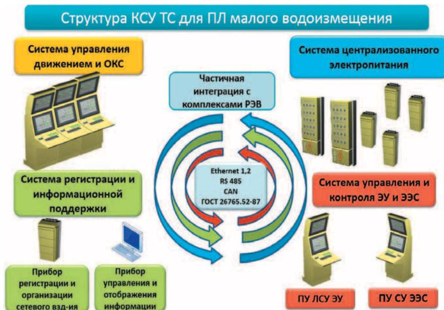
Рис. 2. Структура КСУ ТС перспективной ПЛ малого водоизмещения
