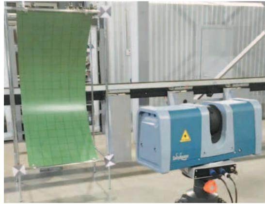
Рис. 4. Проведение измерений при помощи лазерного сканера и маркеров типа «Песочные часы»
