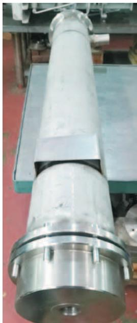
Рис. 6. Мембранный модуль ММ-6
