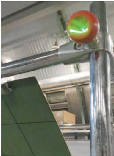
*Рис. 8. Распознавание точек локальной сети с помощью разработанного в АО «ЦТСС» маркера лазерного проектора*
