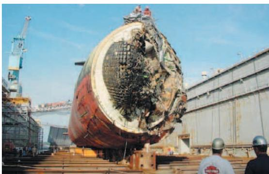
Рис. 1. Поврежденная оконечность ПЛ «Los Angeles» после столкновения с подводной скалой при ее движении в подводном положении
