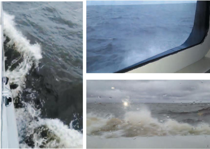
Рис. 9. Мореходные испытания ПС пр. PV09 (фактическая забрызгиваемость окон в носовой части судна на расчетной волне)
