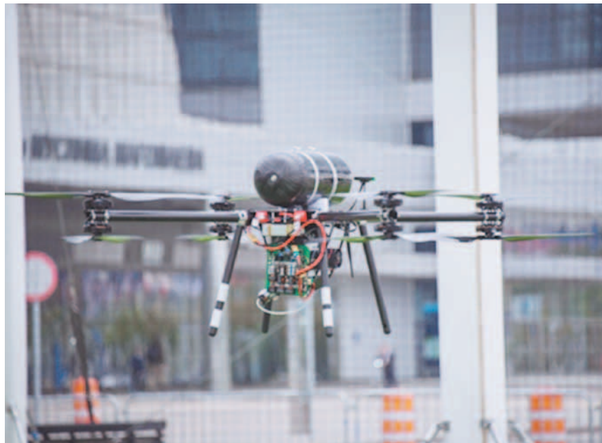
Рис. 3. БПЛА с системой энергоснабжения на основе ТЭ
