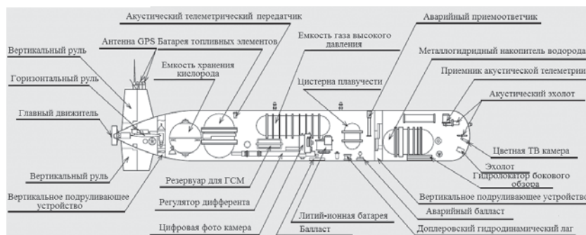
Рис. 5. Схема компоновки японского АНПА с энергетическим отсеком, спроектированным под ЭХГ с интерметаллидным хранением водорода
