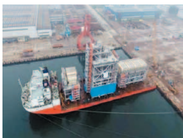
Рис. 4. Пример погрузки и перевозки блоков завода СПГ в Китае
