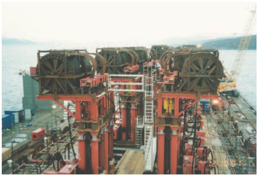
Рис. 6. Баржа «Гигант-4» и смонтированный на ней судоподъемный комплекс для подъема АПЛ К-141 «Курск»
