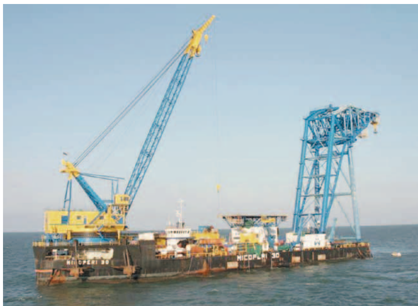
Рис. 4. Многофункциональное крановое судно «Микопери-30», обладающее поворотным и неповоротным крановыми строениями
