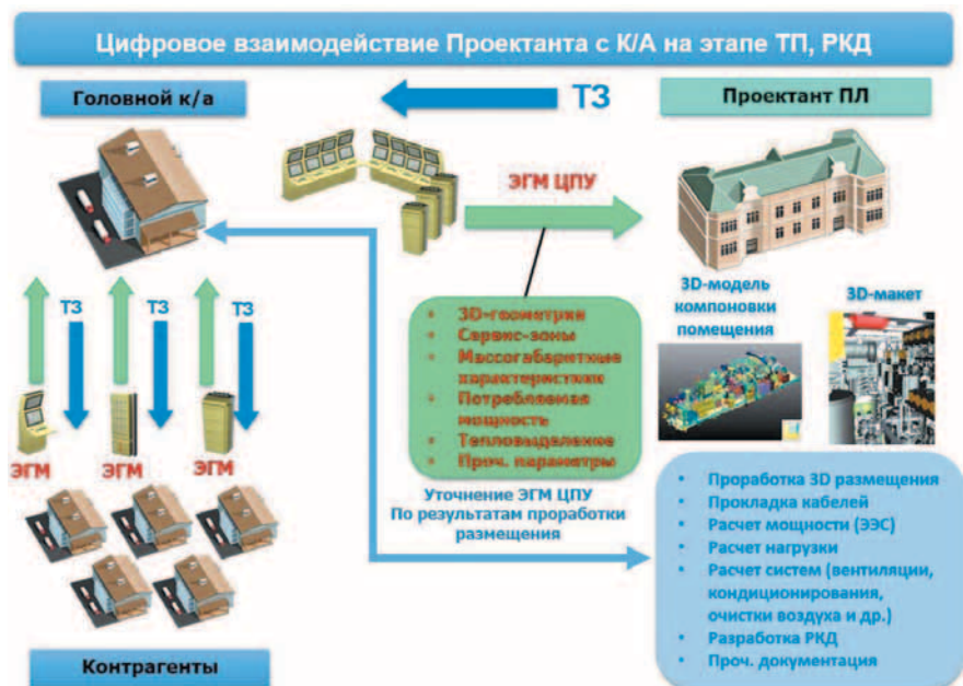
Рис. 1. Перспективная схема цифрового взаимодействия контрагента и проектанта
