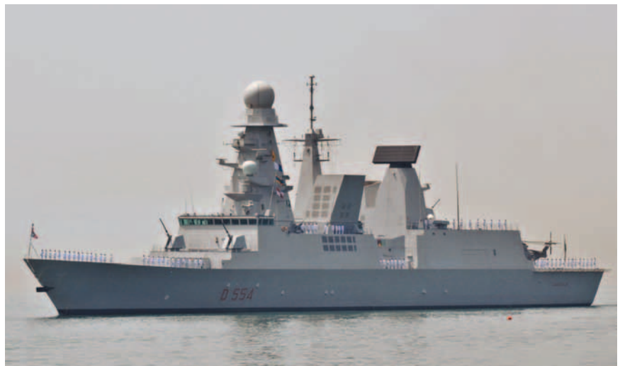
Итальянский эсминец типа «Horizon», оснащенный системой PAAMS
