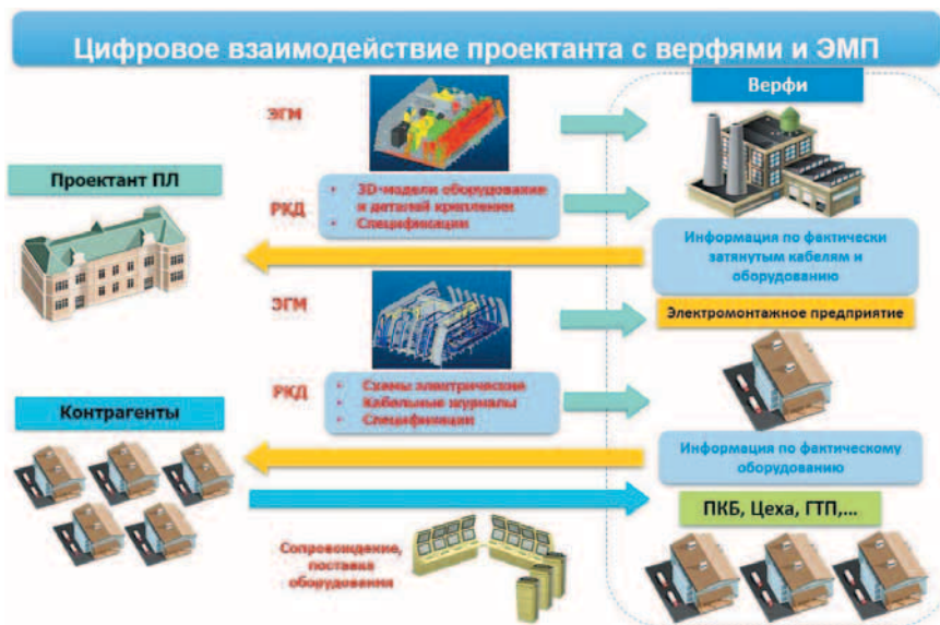
Рис. 2. Перспективная схема цифрового взаимодействия проектанта с верфями и электромонтажным предприятием
