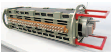
Рис. 1. Li-FePO 4 аккумуляторная батарея
