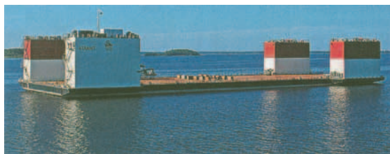
Рис. 1. Металлический плавучий док грузоподъемностью 1000 т, построенный в 1910 г.
