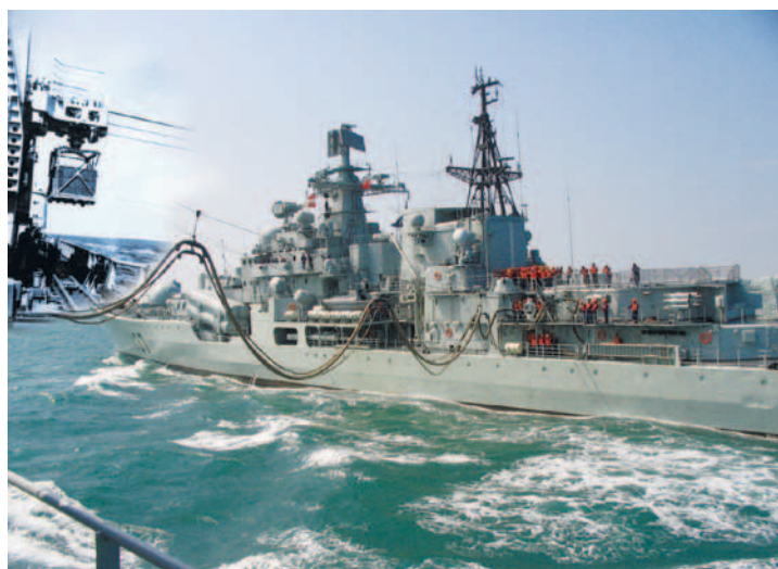
Рис. 1. Устройство передачи сухих и жидких грузов в море на ходу траверзным способом
