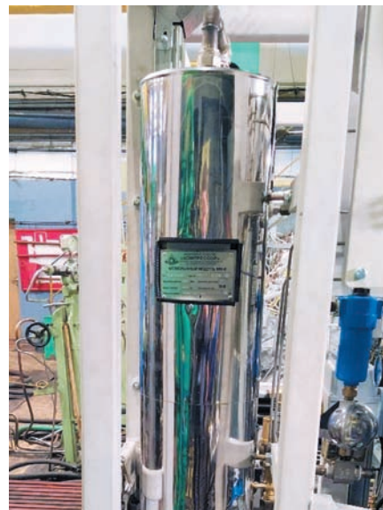
Рис. 4. Воздухоразделительный модуль в теплоизоляционном кожухе ММ-6
