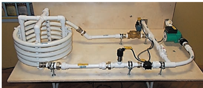
Рис 1. Экспериментальный стенд определения параметров гидроудара и испытания устройств гашения ударных скачков давления
