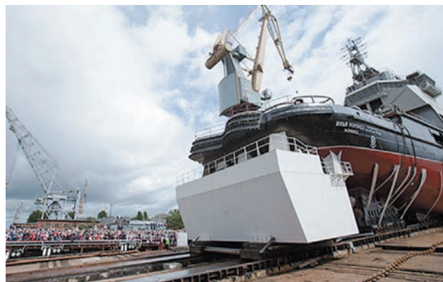
Рис. 2. Спуск ледокола пр. 21180 с использованием кормового понтона
