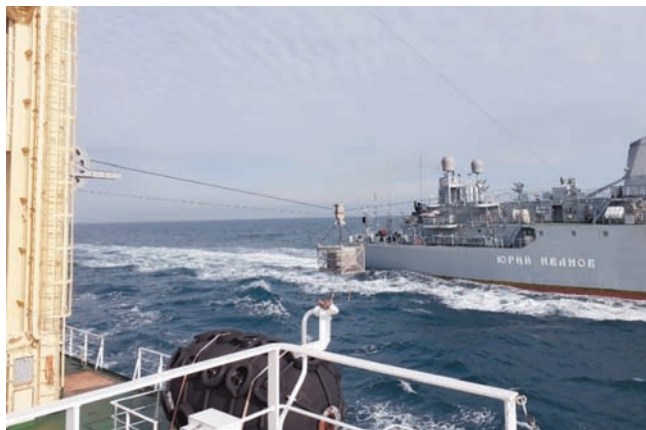
Рис. 8. Проверка работоспособности УПГ при передаче сухих грузов траверзным способом на судно связи «Юрий Иванов»
