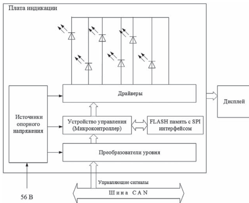
Рис. 6. Структурная схема блока индикации
