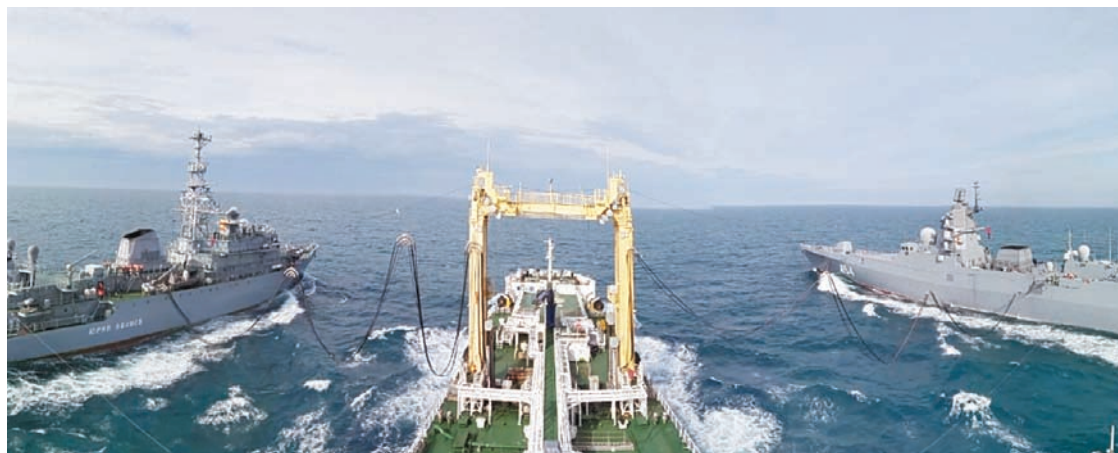
Рис. 6. Испытания УПГ по одновременной передаче жидких грузов траверзным способом на ходу на фрегат «Адмирал флота Касатонов» и судно связи «Юрий Иванов»
