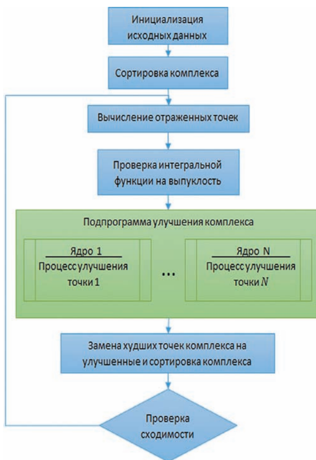
Рис. 3. Структурная схема алгоритма оптимизации
