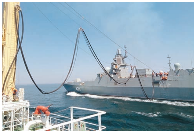
Рис. 3. Испытания УПГ по передаче жидких грузов траверзным способом с каждого борта (а, б) на этапе ЗХИ
