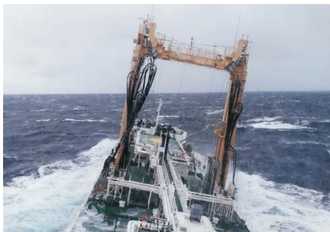
Рис. 10. Мореходные испытания танкера пр. 23130
