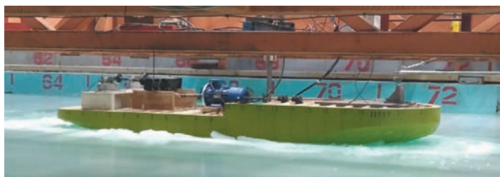
Рис. 2. Проведение модельных испытаний в ледовом опытовом бассейне
