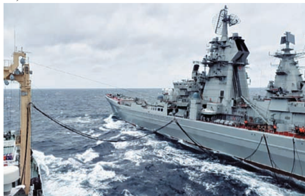
Рис. 8. Проверка работоспособности УПГ при передаче сухих грузов траверзным способом на судно связи «Юрий Иванов»
