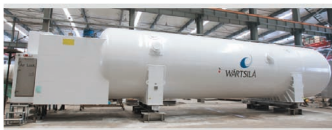
Рис. 11. Емкости хранения газомоторного топлива
