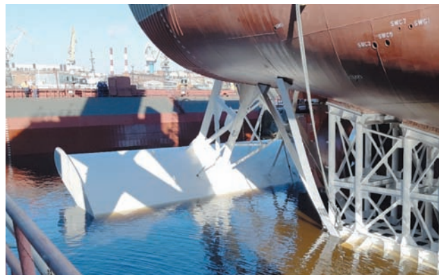
Рис. 4. Кормовое крыло, установленное на траулере пр. СТ-192
