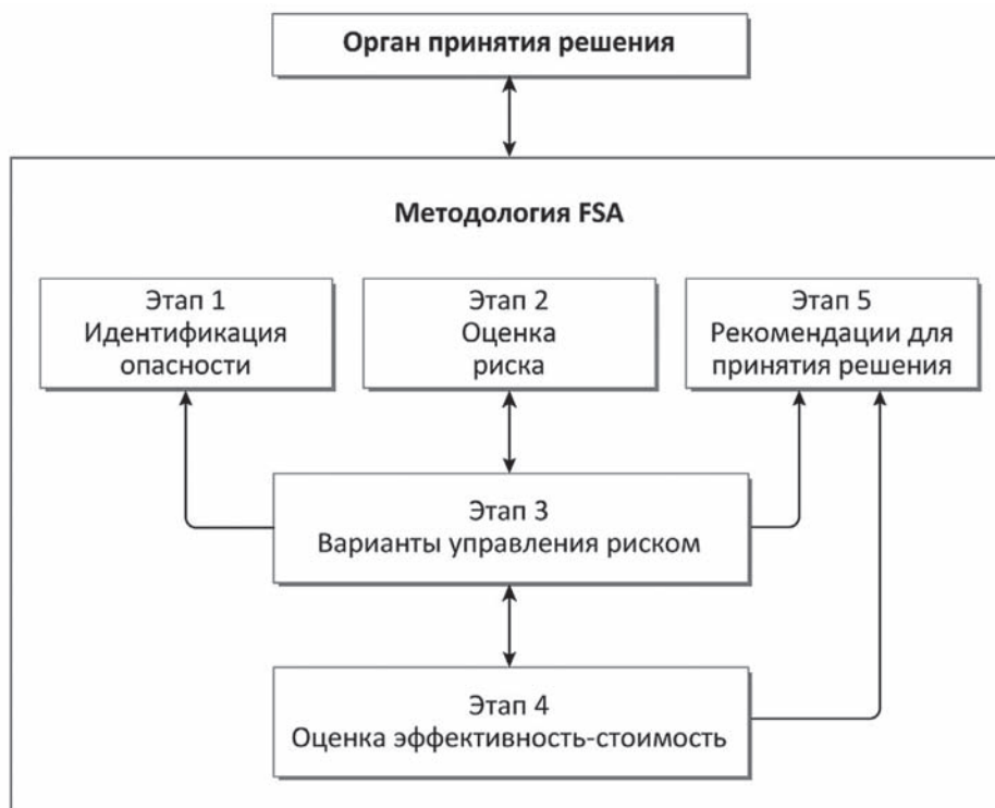
Рис. 1. Структурная схема методологии FSA
