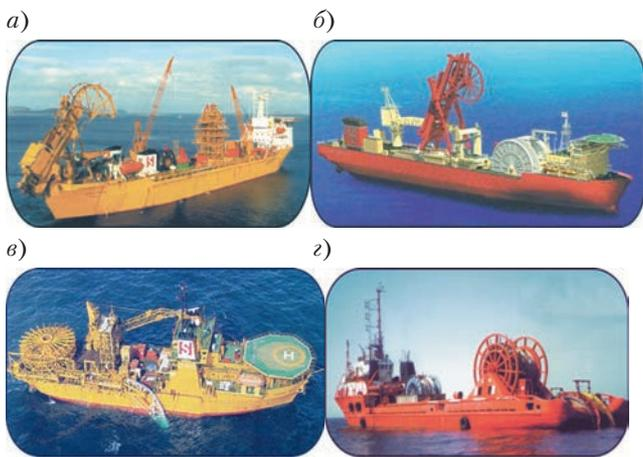
Рис. 16. Трубоукладочные суда с системой динамического позиционирования, укладывающие трубопровод методом сматывания: а – «SeaWay Falcon» с кормовым расположением наклонной рамы; б – «Deer Blue» с наклонной рамой в средней части корпуса; в – «SeaWay Condor» с горизонтальным барабаном и бортовым направляющим; г – «Bazalt» с вертикальным барабаном и кормовым желобом
