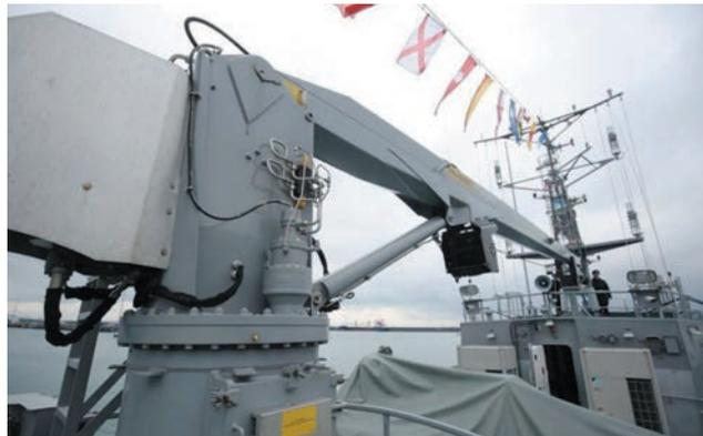
**Рис. 10. Грузовой электрогидравлический кран грузоподъемностью 3 т для выгрузки практических изделий на причальную стенку**
