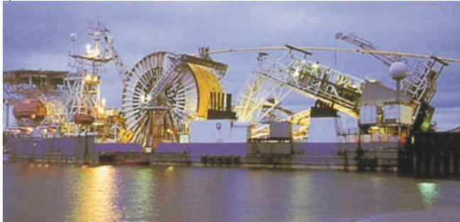
Рис. 15. Перематка трубопровода с берегового барабана на судовой: а – схема перематки; б – трубоукладочное судно «Seaway Kestrel» в процессе перематки
