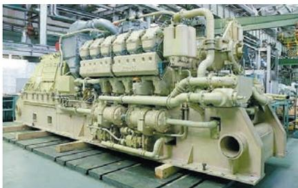
Рис. 5. Дизель-генератор АДГ-1600 с дизелем 12ДМ-21
