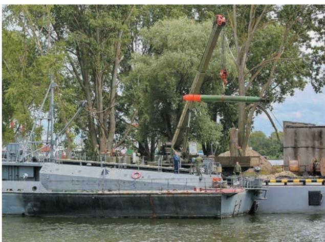
**Рис. 7. Кормовой люк (кюз) с люковым закрытием для выгрузки практических изделий на катере-торпедолове пр. 1388**
