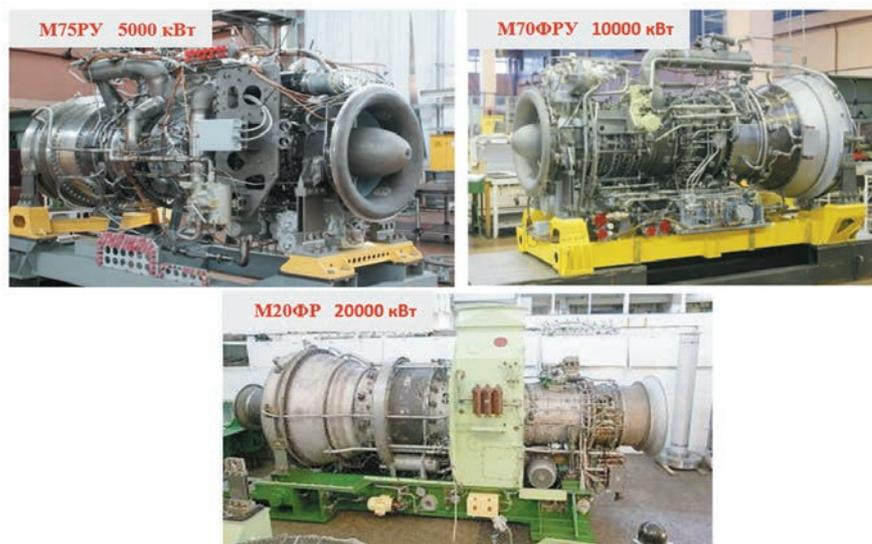
Рис. 13. Семейство корабельных ГТД разработки ПАО «ОДК-Сатурн»
