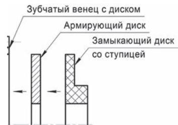
Рис. 3. Зубчатое колесо с армирующим диском
