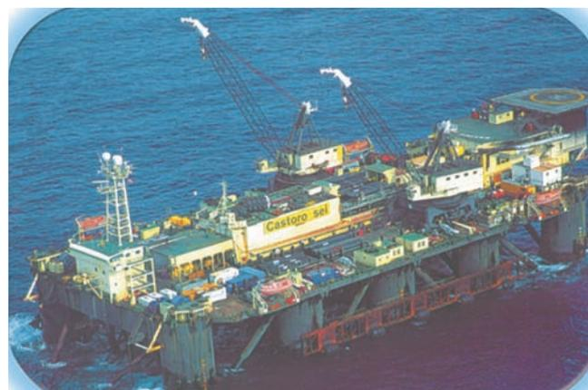
Рис. 12. Полупогружная трубоукладочная установка «Castoro Sei»
