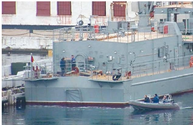
**Рис. 9. Кормовое специальное люковое закрытие на транце катере-торпедолове пр. 1388нзт**
