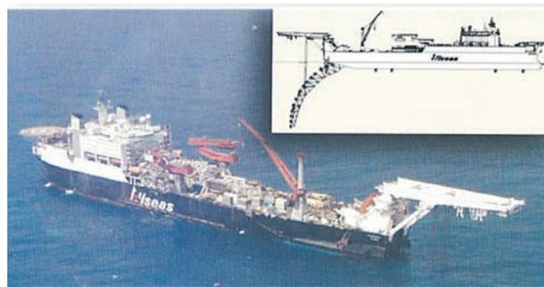
Рис. 20. Трубоукладочное судно «Solitaire», обеспечивающее укладку по S-образной кривой
