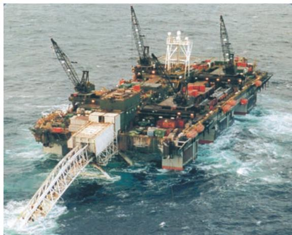
Рис. 10. Полупогружная трубоукладочная установка «LB-200»
