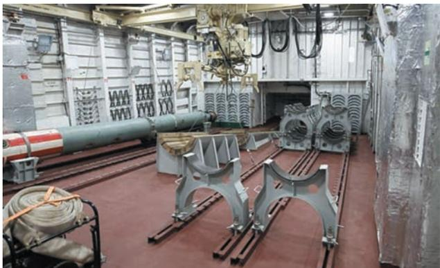
**Рис. 11. Помещение (элинг) для хранения поднятых на борт практических изделий с мостовым гидравлическим краном на катере-торпедолове пр. 1388нзт**
