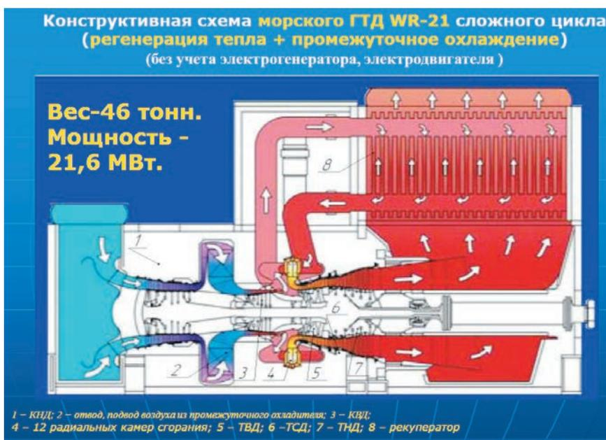
Рис. 11. Особенности конструктивного исполнения ГТД WR-21 сложного цикла компании Rolls-Royce
