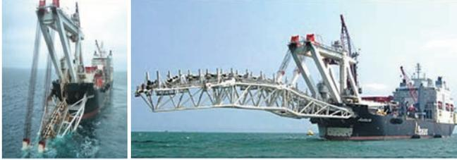
Рис. 21. Общий вид трубоукладочного судна «Audacia»
