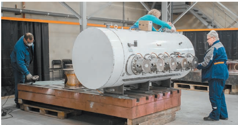
Подогреватель пресной воды электрический ПЭ 1000/200-Г. Окончательная инспекция (проверка электрической части, пломбировка) перед упаковкой и отгрузкой заказчику
