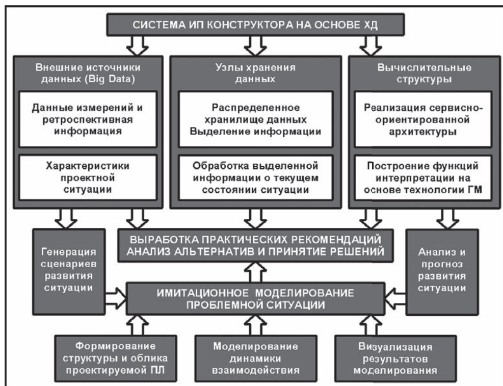
Рис. 1. Система ИП конструктора на основе программного комплекса ХД
