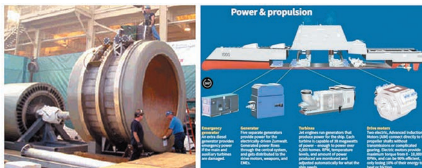
Рис. 11. Корабельный ВТСИ электродвигатель мощностью 36,5 МВт для эсминца «Zumwalt»
