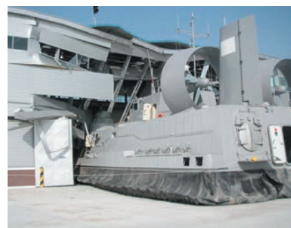
Рис. 5. Последствия аварии головного заказа пр. 12061Э вследствие неконтролируемого ускорения при выходе на горизонтальную стояночную площадку базы № 226 Медо, Инчхон (Юж. Корея)
