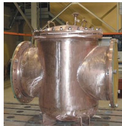
Новейший фильтр заборной воды ФЗВ ДУ600 из медно-никелевого сплава для грузопассажирских автомобильно-железнодорожных паромов пр. CNF11CPD, которые строятся на ПАО «Амурский судостроительный завод»
