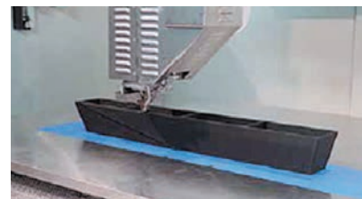
Процесс 3D печати модельной оснастки
