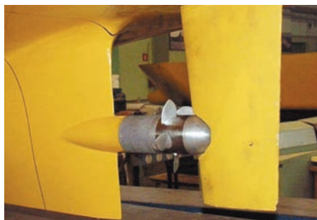
Рис. 3. Модель МДЛД с контрпропеллером за корпусом судна: а – режим энергосбережения, моделирование полного хода (см. рис. 1, а); б – моделирование малого хода (см. рис. 1, б)
