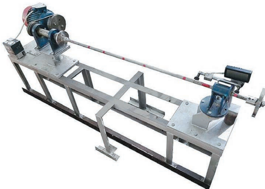
Рис. 1. Экспериментальная установка для изучения колебаний системы валопровода судна
