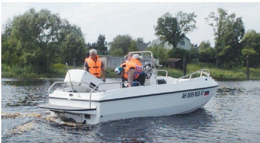
Испытания стационарного маринизированного дизельного двигателя В522, разработанного ООО «Винета» на базе серийного ЗМ351432, в составе маломерного глиссирующего катера «Винета-550»
