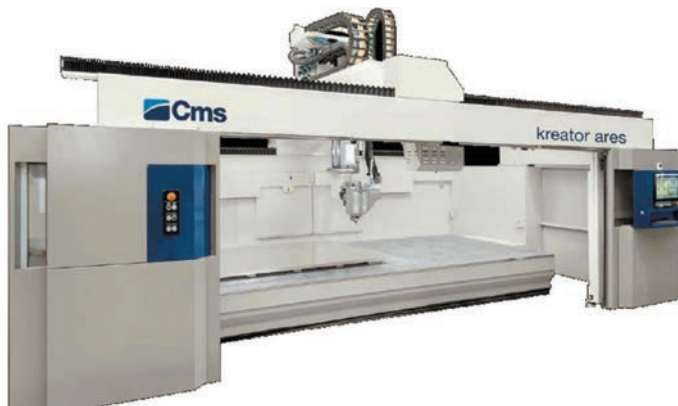
Пятиосевой высокоскоростной фрезерный обрабатывающий центр с ЧПУ и с функцией 3D печати CMS ARES KREATOR
