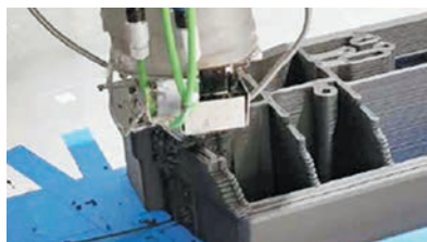
Процесс 3D печати изделия с заранее спроектированными полостями для работы под вакуумом
