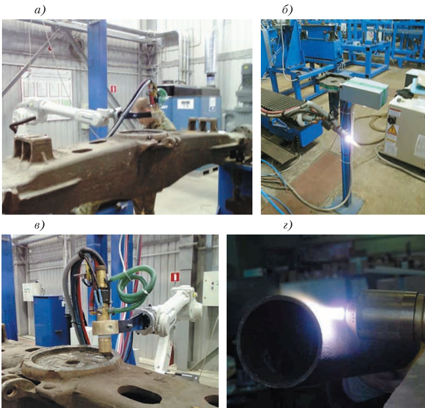
Рис. 1. Специальная установка плазменной очистки перед операцией наплавки в экспериментальном депо ОАО «РЖД» (а–z)
