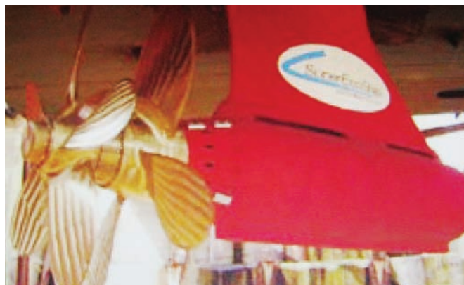
Рис. 2. ДРК с СГВ и размещением гребных электродвигателей в гондоле
