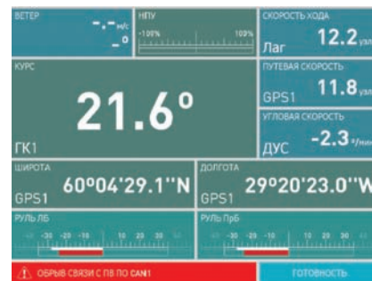
Рис. 3. Рабочие экраны панели авторулевого «Румб»
