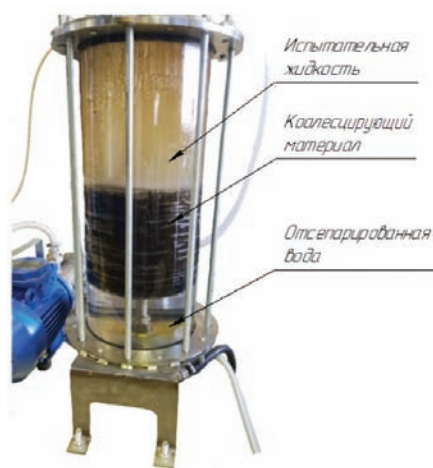
Рис. 1. Испытательный стенд с коалесцентным материалом
