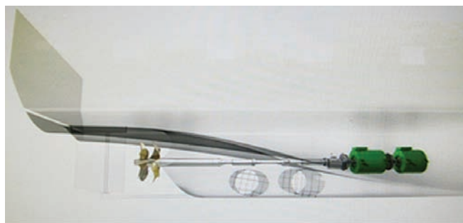
Рис. 1. Классическая компоновка пропульсивной установки с СГВ
