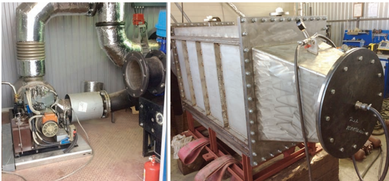
Рис. 3. Внешний вид экспериментального стенда с горячим замкнутым контуром
