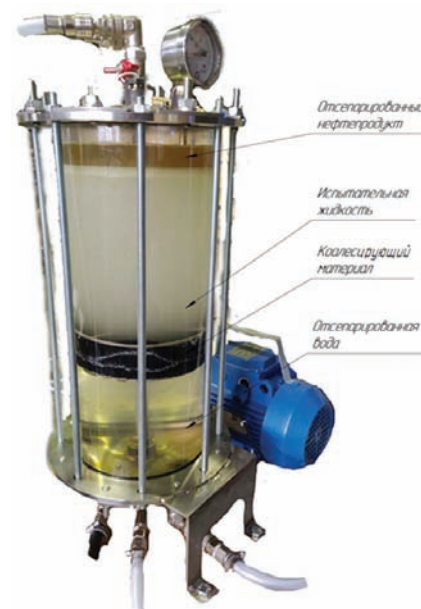
Рис. 2. Процесс работы коалесцирующего материала
