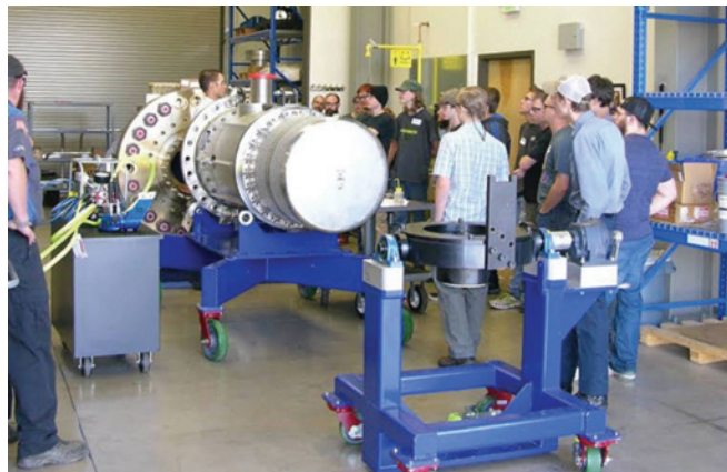
Рис. 4. Турбонасосный гидроагрегат Mk-21 в сборочном цехе компании Barber-Nichols Inc.
