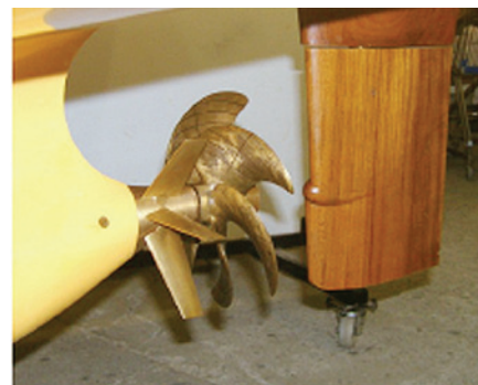
Рис. 9. Кормовая оконечность модели судна с движителем DSME с закручивающим аппаратом (DSME – pre-swirl stator), опытовый бассейн HSVA [22]
