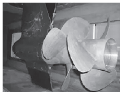
Рис. 4. Модель СГВ в кавитационной трубе Женевского университета (University of Genoa Cavitation Tunnel) [7]
