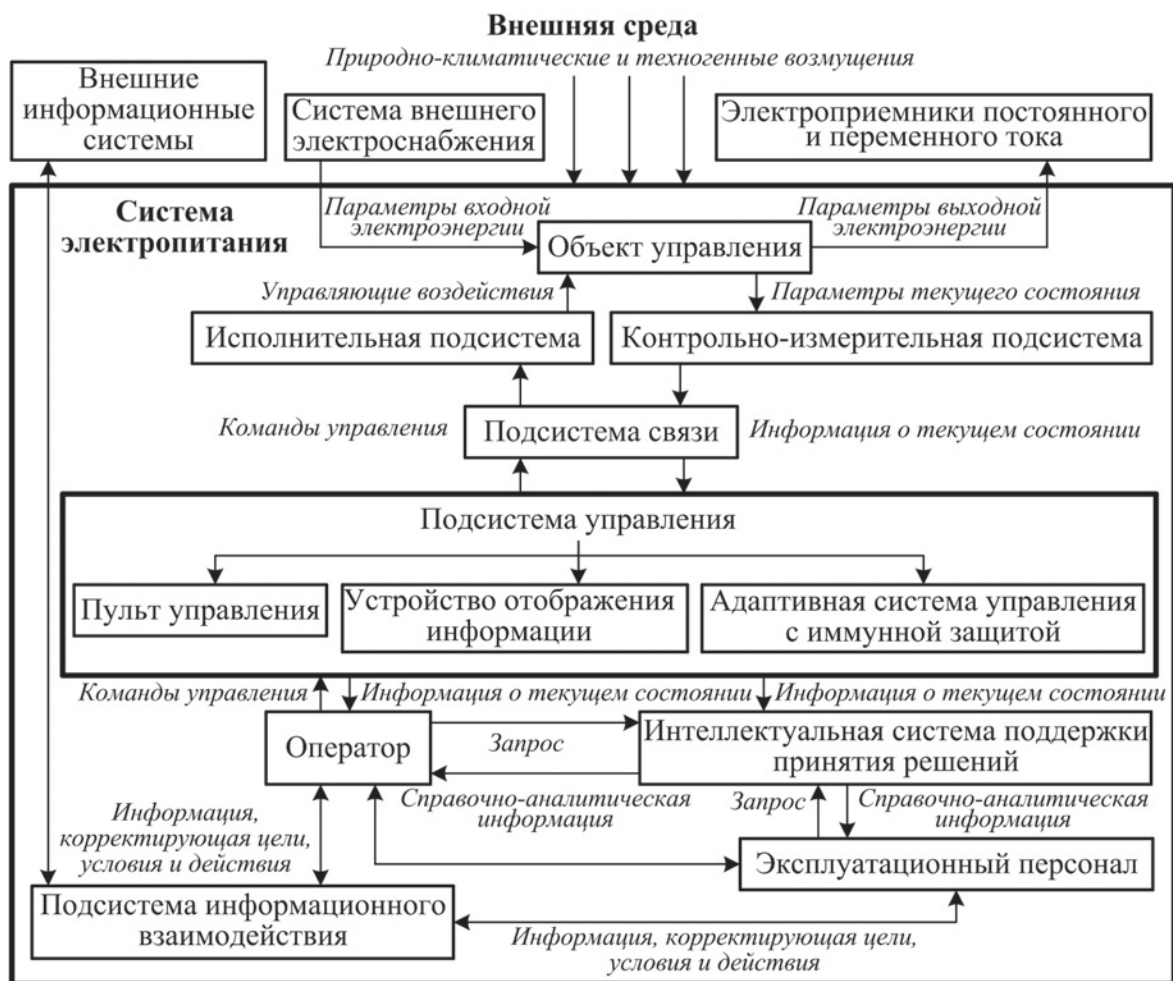
Рис. 7. Концептуальная модель системы электропитания объектов ответственного назначения с адаптивным управлением
