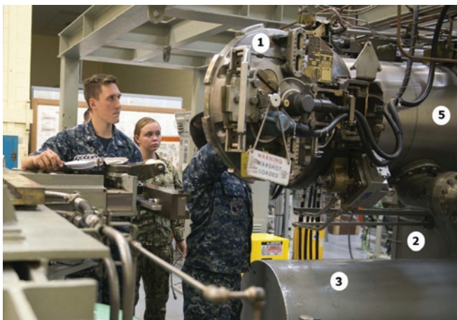
Рис. 2. Торпедный аппарат с системой стрельбы Mk-19 в учебном центре подготовки экипажей 1 – задняя крышка ТА, 2 – выгорodka импульсной цистерны, 3 – корпус пневматической турбины Mk-19, 4 – труба заднего клапана осушения, 5 – задняя труба ТА
