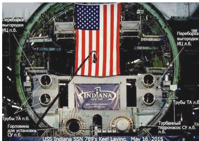
Рис. 5. Трубы торпедного аппарата, горловина для установки стреляющего устройства (СУ) и турбонасосный гидроагрегат на АПЛ «Индиана»
