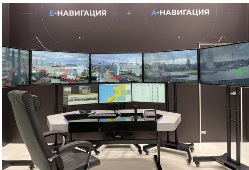
Рис. 1. Пост дистанционного управления МАНС
