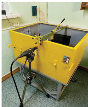
Рис. 1. Экспериментальная установка (а), установка, совместно с лазерным виброметром (на переднем плане) (б) и лазерный виброметр (в)
