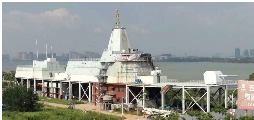
Рис. 10. Натурный макет надстройки эсминца пр. 055 на испытательном полигоне в Ухани
