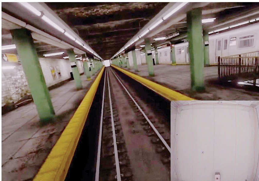
Рис. 1. Квадрокоптер перемещается в пустом помещении (нижний правый угол), в то время как его система управления «видит» виртуальное окружение
