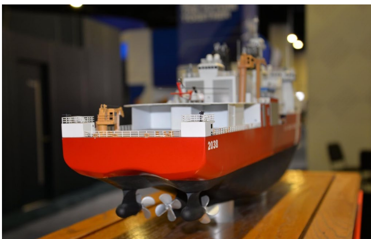
Рис. 5. Модель тяжелого ледокола, создаваемого по программе Polar Security Cutter. Хорошо видны два Азипода и винт в диаметральной плоскости судна Канады
