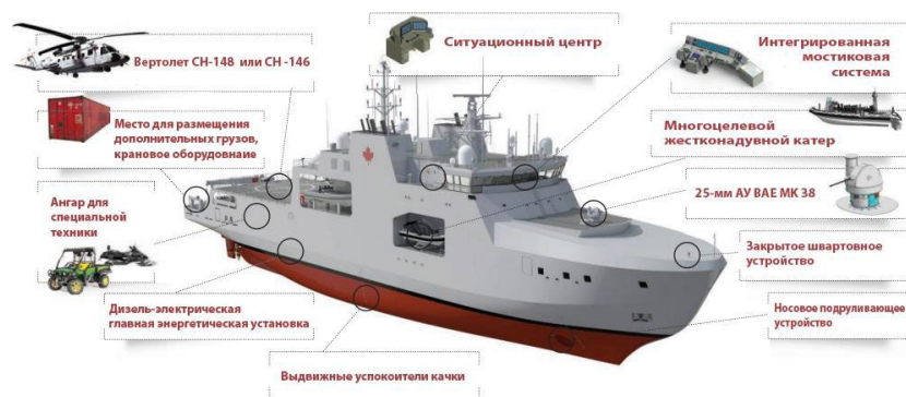
Рис. 9. Схема основных элементов вооружения и оборудования патрульных кораблей типа «Harry De Wolf»
