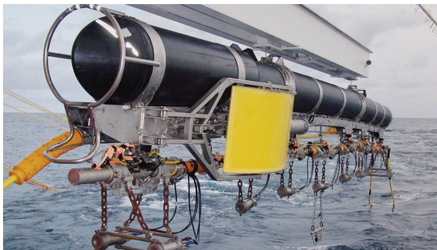
Рис. 2. Система управления позиционированием буксируемых морских сейсмостойков. Фото с сайта https://www.pgs.com/ [16]
