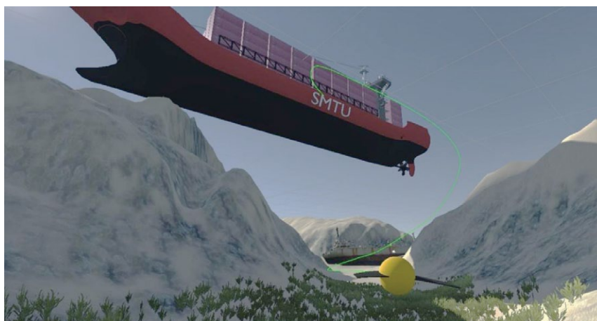
Рис. 5. Управление виртуальным объектом с помощью реальной бортовой системы автоматического управления
