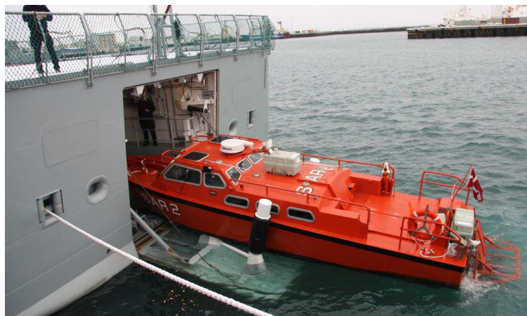
Рис. 13. Спасательный катер заходит в ангар корабля типа «Knud Rasmussen»
