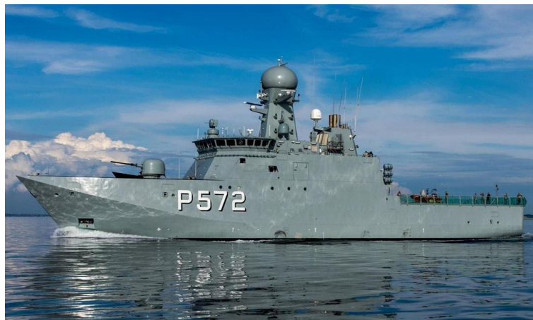
Рис. 12. Патрульный корабль «Lauge Koch» (третий корабль типа «Knud Rasmussen»). Хорошо виден колпак РЛС – его основное внешнее отличие от кораблей серии
