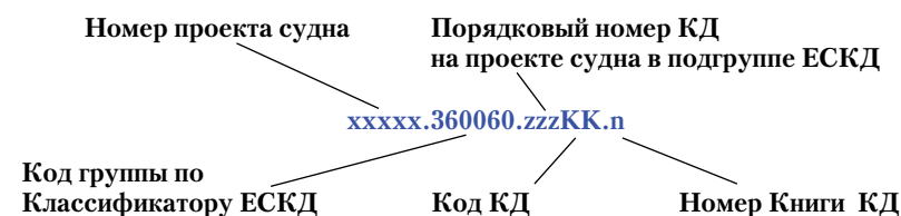
Рис. 1. Структура обозначения конструкторского документа
