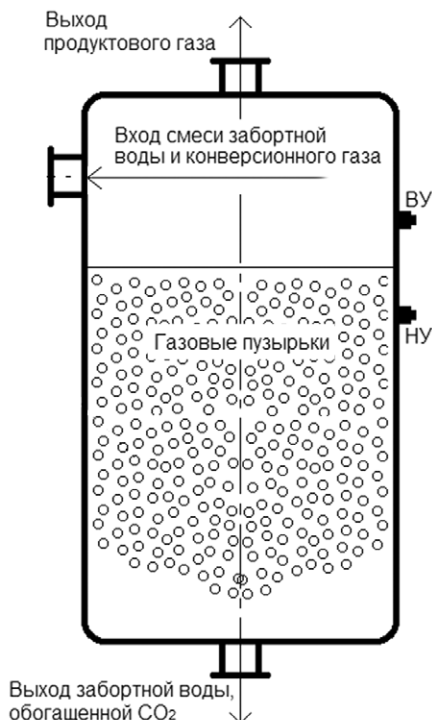
Рис. 1. Принципиальная схема абсорбера ВУ – верхний уровень; НУ – нижний уровень
