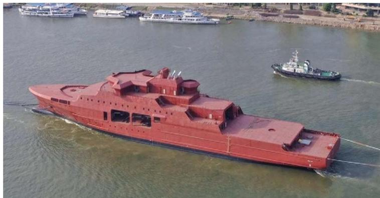
Рис. 16. Буксировка корпуса ледокола типа «Jan Mayen» на достройку
