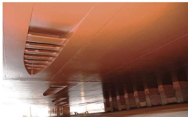
Рис. 7. Устройства выпуска воздуха на днище судна [17]
