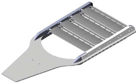
Рис. 11. Внешний вид лопасти ласты с самостабилизирующимися лопастями
