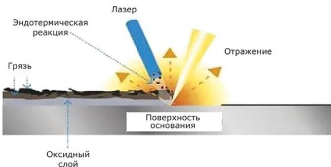
Рис. 1. Принцип действия лазерной очистки [4]
