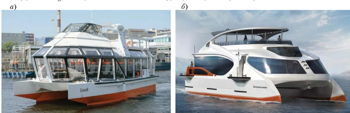
Рис. 1. Электрические суда, построенные на верфи «Эмперимум»: а – «Ecovolt 2.0» (длина наибольшая  $L_{OA} = 22,5$  м, скорость  $V_s = 15$  уз, мощность двигателей  $P_s = 2 \times 200$  кВт); б – «Eco cruiser» ( $L_{OA} = 31,3$  м,  $V_s = 22$  уз,  $P_s = 2 \times 400$  кВт)
