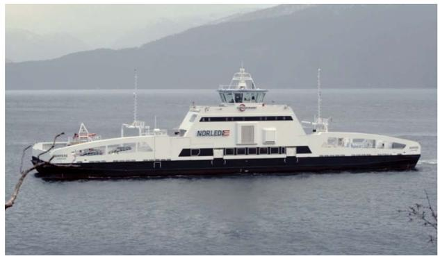
Рис. 3. Паром «Ампер» ( $L_{\text{ОА}} = 80 \text{ м}$ ,  $B = 21 \text{ м}$ ,  $T = 3,0 \text{ м}$ )
