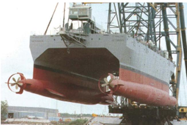
Рис. 4. Корабль акустического дозора типа СМПВ (дуплус) [11]
