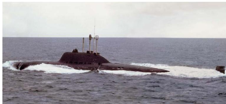
**Крейсерская многоцелевая титановая комплексно-автоматизированная АПЛ пр. 705 с ракетно-торпедным вооружением**
