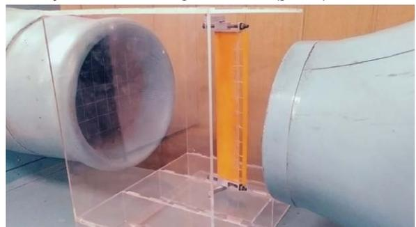
Рис. 7. Экспериментальная установка с системой симметричных крыловых профилей
