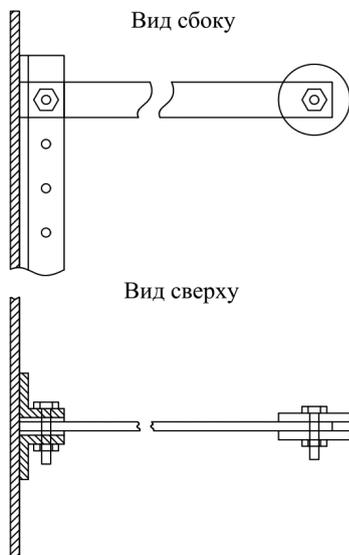
Рис. 2. Вид консольной балки
