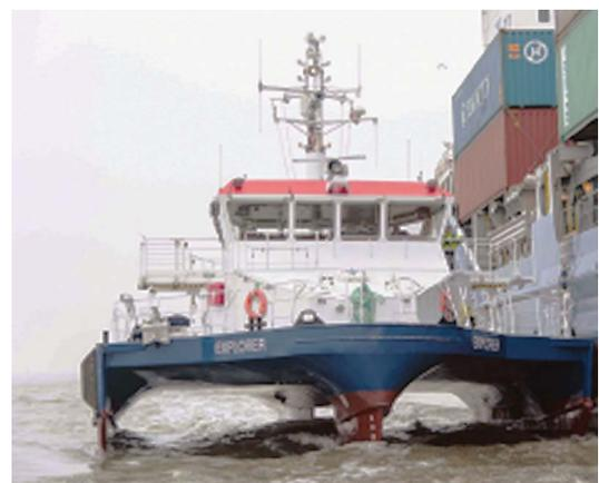
Рис. 5. Лоцманское судно СМПВ с двумя аутригерами [11]
