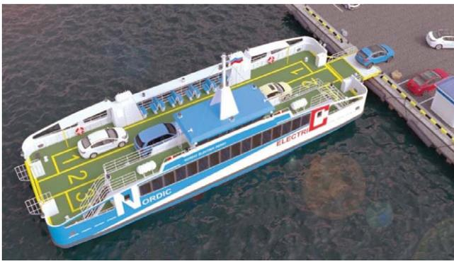
Рис. 2. Паром пр. 19411 ( $L_{\text{ОА}} = 36 \text{ м}$ ,  $B = 10 \text{ м}$ ,  $T = 1,8 \text{ м}$ )
