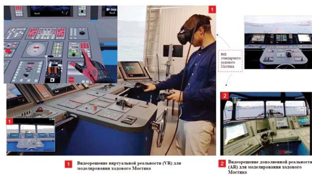
Рис. 4. Функции VR/AR/Real ходового мостика: Real – правый верхний угол: вид стандартного ходового мостика тренажера, VR – слева: реализованная в VR-шлеме виртуальная реальность, AR – в правом нижнем углу: в верхней полусфере представлена сгенерированная дополненная реальность, а в нижней части – вид реальных консолей, получаемый с помощью стандартных видеокамер, которые в AR-шлеме объединяются в единый видеокадр изображения (как представлено на рисунке)
