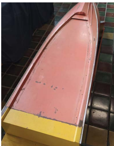
Рис. 2. Обводы днищевой части модели судна для создания воздушной каверны
