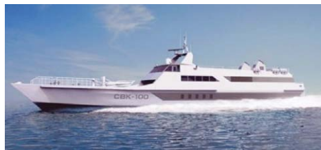
Рис. 12. Морское грузопассажирское судно с воздушной каверной на днище пр. 23210 «СВК-100»
