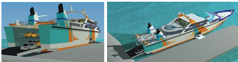
Рис. 14. Морской паром для перевозки пассажиров и автомобилей «СВК-1200»
