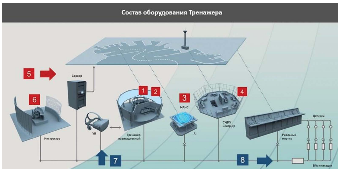
Рис. 1. Состав навигационного тренажера для подготовки специалистов автономного судовождения 1, 2 – навигационный мостик для двух вариантов подготовки; 3 – МАНС для различных классов, определенных РМРС; 4 – ЦДУ/СУДС для двух вариантов подготовки; 5 – моделирующая среда; 6 – место инструктора; 7 – устройства виртуальной и дополненной реальности для проведения обучения; 8 – интерфейсы для подключения реального судового или учебного оборудования, разработанного в ходе выполнения учебных работ по конструированию оборудования МАНС
