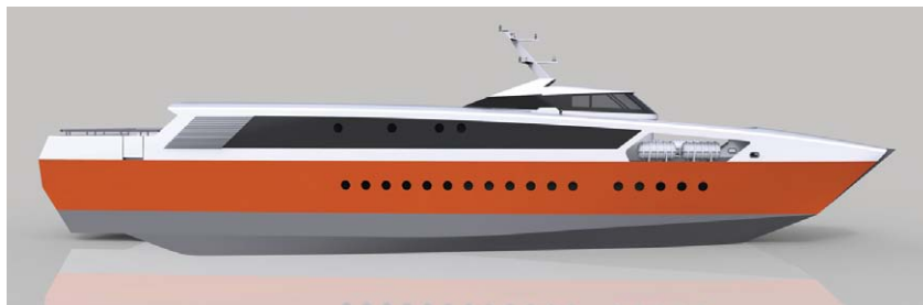
Рис. 12. Морское грузопассажирское судно с воздушной каверной на днище пр. 23210 «СВК-100»
