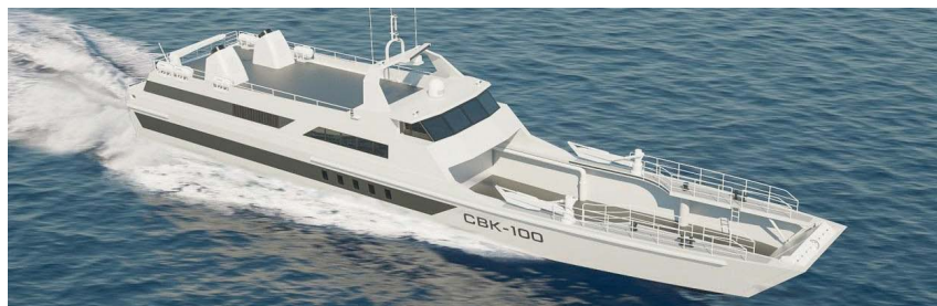
Рис. 11. Морское грузопассажирское судно с воздушной каверной на днище пр. 23220 «СВК-10»
