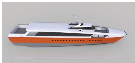
Рис. 13. Морское пассажирское судно с воздушной каверной на днище «Сивуч» пр. 04480
