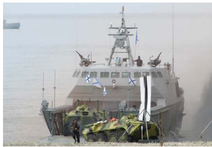
Рис. 8. Транспортно-десантный катер с воздушной каверной пр. 21820 «Дюгонь»
