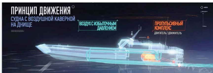
Рис. 1. Схема работы каверны
