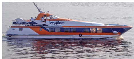
Рис. 9. Речной мелкосидящий теплоход пр. 14200 «Линда»
