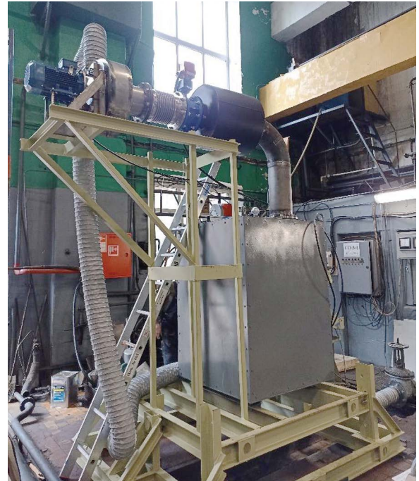
Рис. 6. Стенд для испытания инсинераторов при качке
