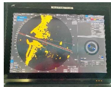
Рис. 14. Прием генерации радиолокационного видео в тренажере и реального радарного изображения на борту судна в той же точке: а – изображение, имитируемое в тренажере, б – изображение реального судового радара
