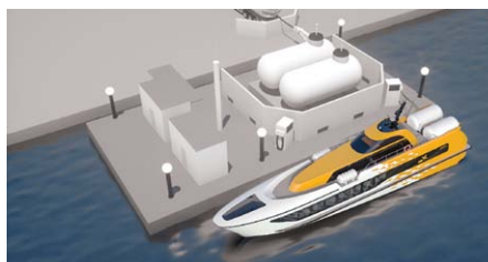
Рис. 10. Пассажирское судно с воздушной каверной проекта «СВК-ЕСО»
