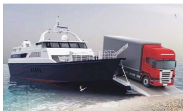
Рис. 12. Морское грузопассажирское судно с воздушной каверной на днище пр. 23210 «СВК-100»
