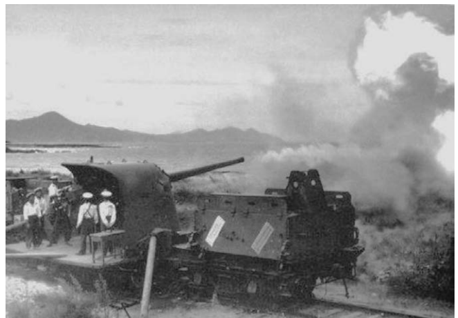
Передаваемая Береговой обороне ВМС НОАК в Порт-Артуре 130-мм железнодорожная артиллерийская установка Б-57 с орудием Б-13-2с
