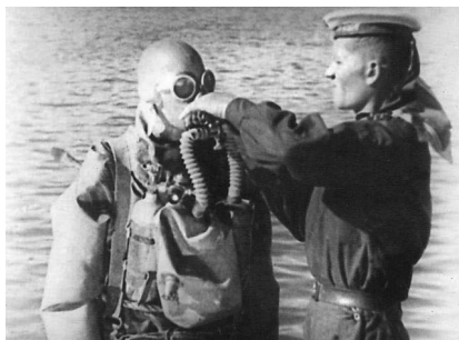
Рис. 9. Индивидуальный спасательный аппарат ИСА с гидрокombineзоном ТУ-1, 1938 г.
