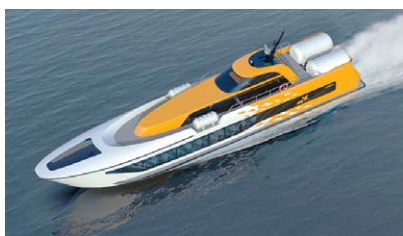
Рис. 10. Пассажирское судно с воздушной каверной проекта «СВК-ЕСО»
