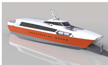
Рис. 13. Морское пассажирское судно с воздушной каверной на днище «Сивуч» пр. 04480
