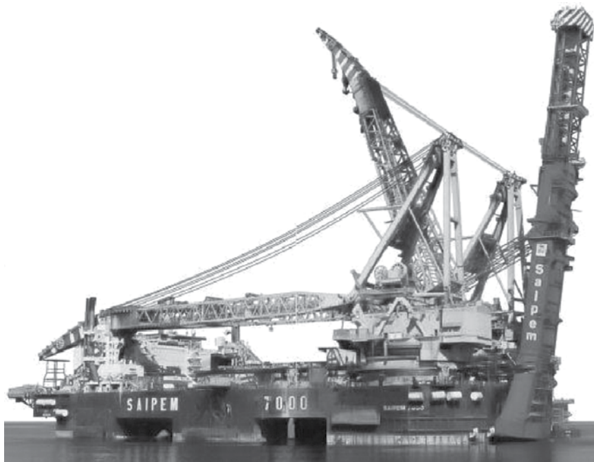
Рис. 3. Плавающий кран «Saipem 7000» (с установкой для укладки подводных трубопроводов)
