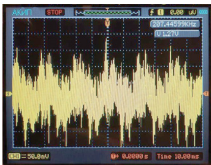
Рис. 1. Реальная форма входного сигнала АСК на объекте
