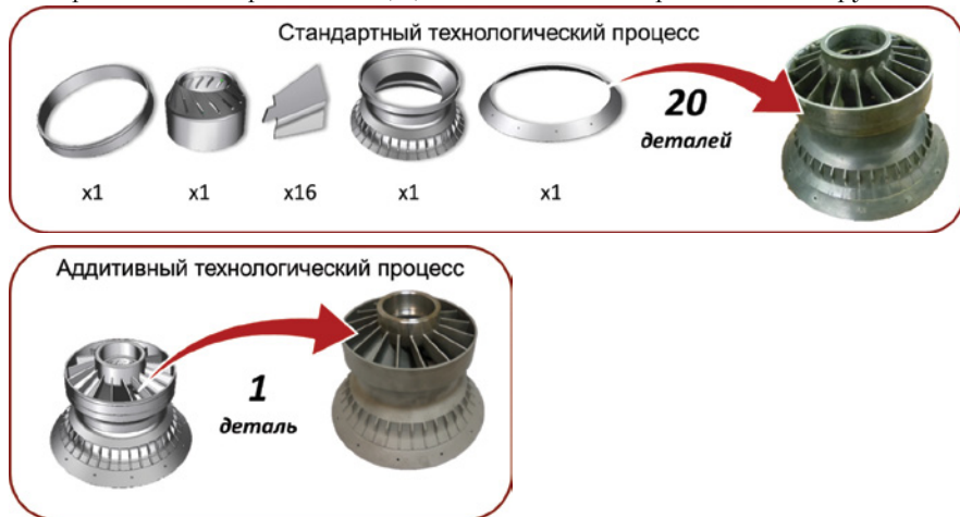
Рис. 1. Стандартный и аддитивный технологические процессы изготовления завихрителя
