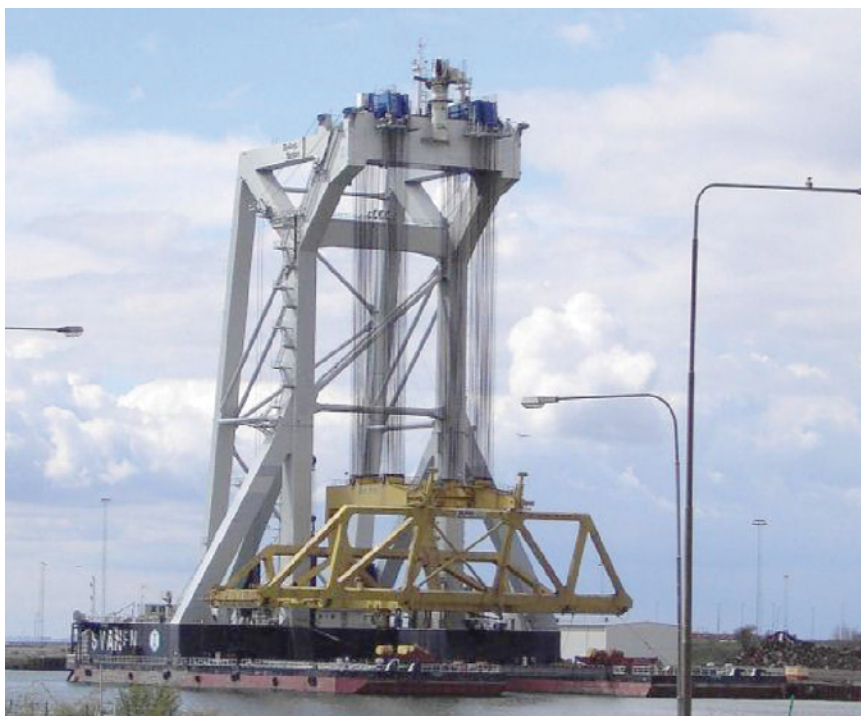
Рис. 8. Плавкран со специальным грузоподъемным устройством
