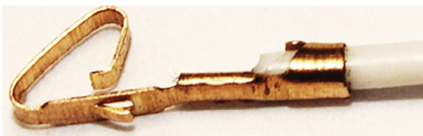
Рис. 1. Лепесток на многожильном проводе для разъема СНПЗ89
