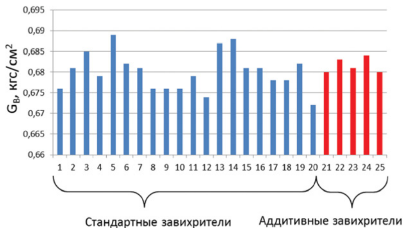
Рис. 2. Расход через завихрители, изготовленные по разным технологиям
