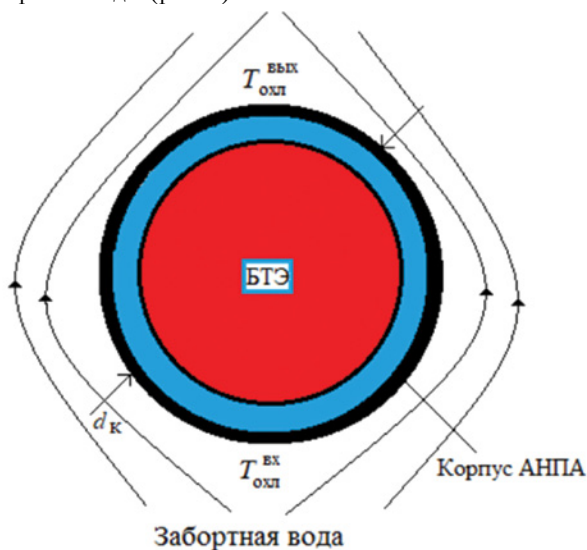
Рис. 1. Картина обтекания корпуса АНПА за счет естественной конвекции в районе энергетического отсека при «зависании» аппарата
