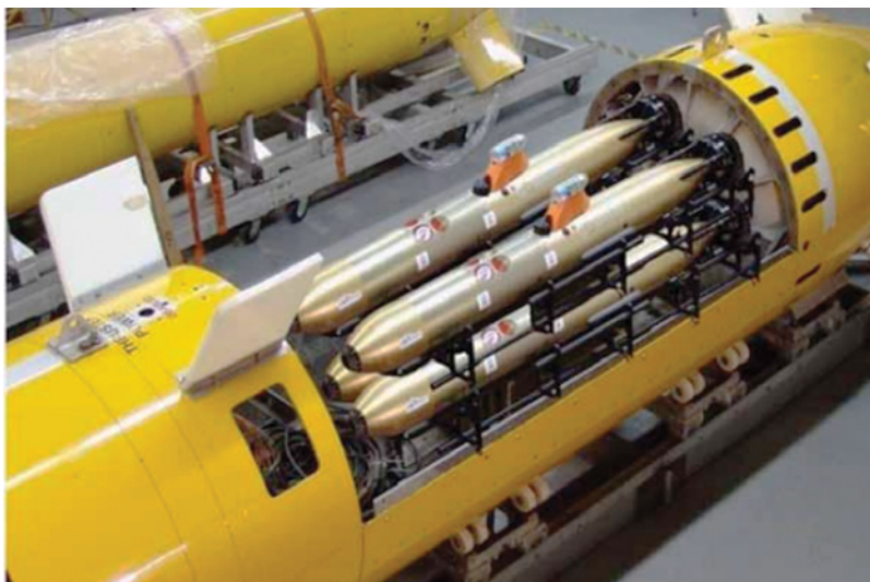
Рис. 4. Расположение малогабаритных НПА в корпусе аппарата «Theseus»
