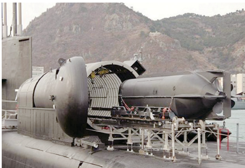
Рис. 2. Ангар системы DDS и обитаемый аппарат сил спецназначения на борту ударной АПЛ типа «Огайо»
