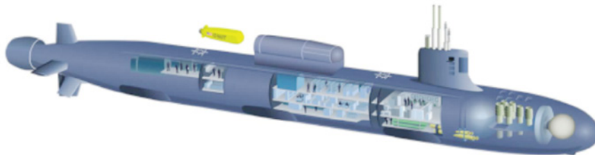
Рис. 1. Пуск и эвакуация НПА LD UUV из (в) прочный герметичный ангар СМН АПЛ типа «Вирджиния»
