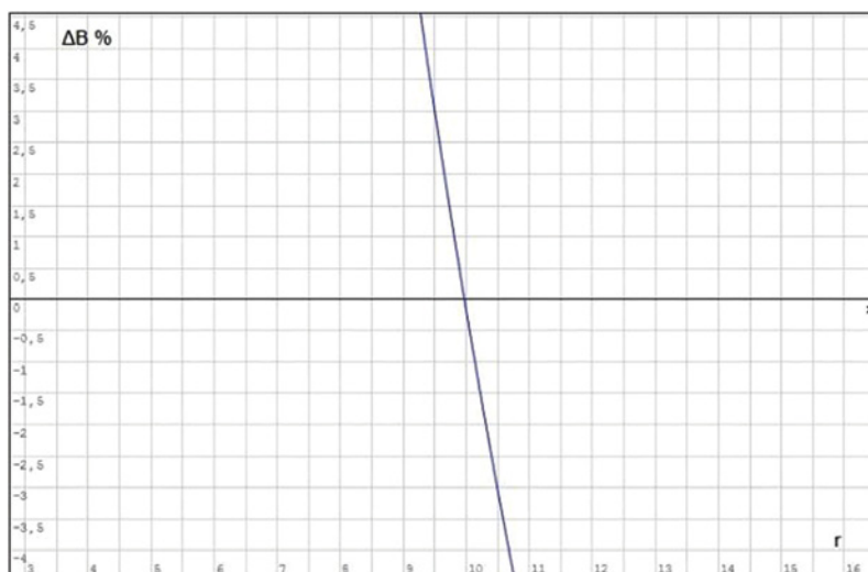
Рис. 9. Максимальная погрешность компенсации НЭМП в зависимости от расстояния (при использовании отсечных компенсационных обмоток)
