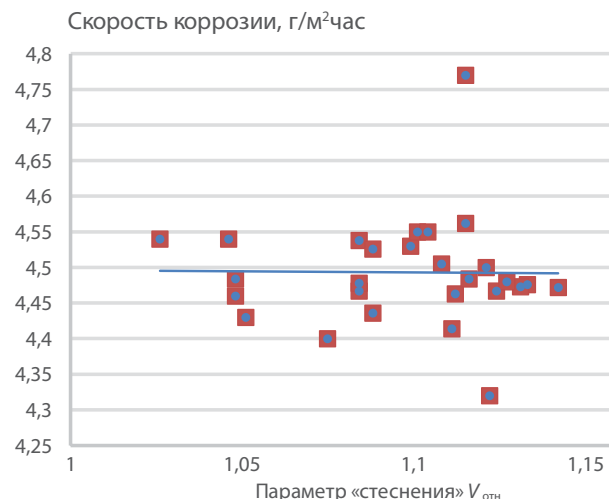
Рис. 1. Связь приведенной скорости коррозионного повреждения сплавов с их параметром «стеснения»
