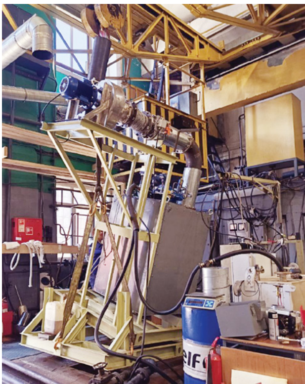
Рис. 4. Стенд для испытаний инсинератора «ИСКРА 10.01» со шламовой цистерной
