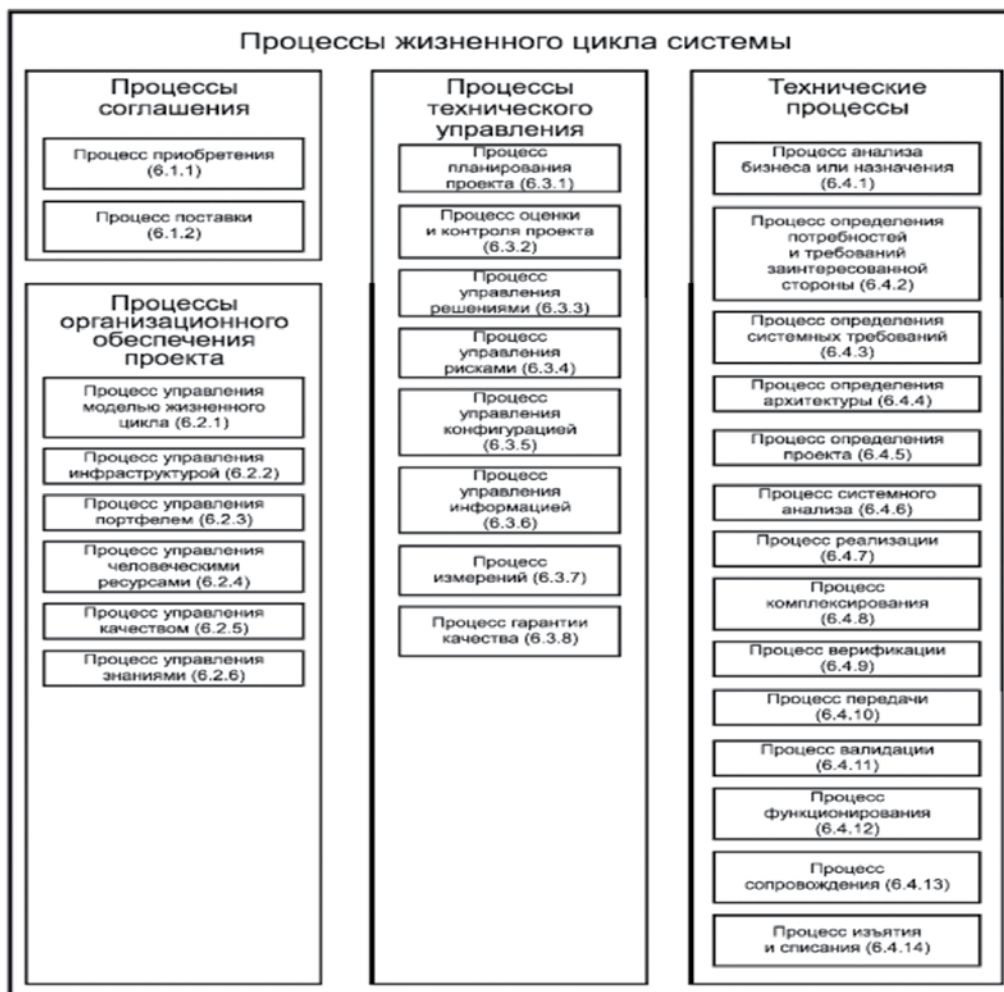
Рис. 4. Процессы жизненного цикла модуля системы управления согласно ГОСТ Р ИСО/МЭК 15704–2022
