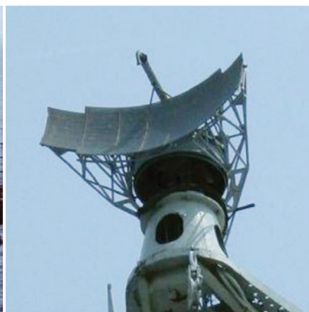
Антенный пост РЛС целеуказания ракетному оружию Н/ЛР-352 и станции опознавания государственной принадлежности «651» на грот-марсе
