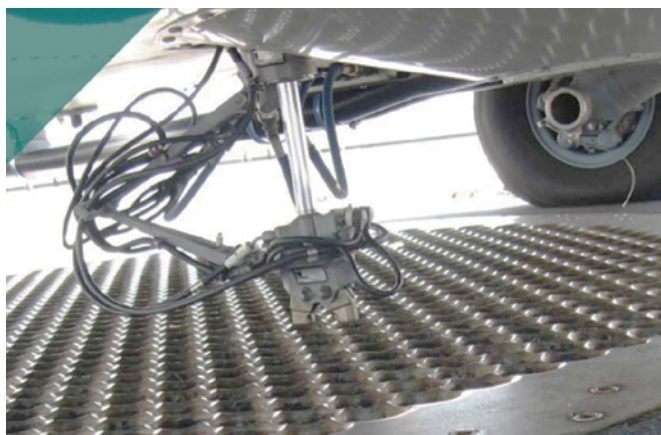
Рис. 35. Палубный замок в зацеплении с палубной решеткой в разных положениях (а–б) URL: https://twitter.com/realkaypius/status/1264574192172687363?lang=ca (дата обращения 07.06.2021); URL: https://www.vdlkti.be/_asset/_public/_site_44/3-Folder-Helicopter-Landing-Grids-VDL_Iv.pdf (дата обращения 11.06.2021).
