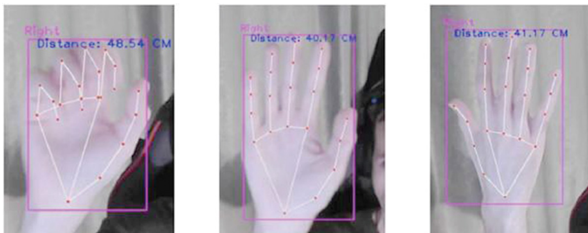
Рис. 3. Распознавание жестов руки на экране оператора с указанием расстояния до руки
