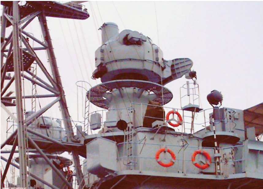
Фрагмент фок-мачты и СВП-42/50 с РЛС управления стрельбой Н/ЛР-343 корабля пр. 051
