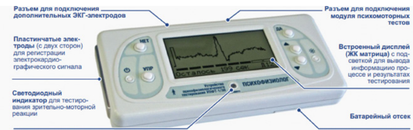
Рис. 2. Устройство психофизиологического тестирования УПФТ-1/30 [22]
