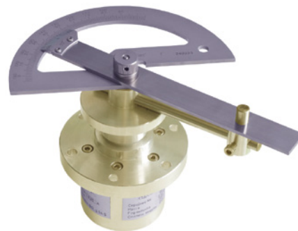
Рис. 3. Внешний вид датчика с установленным угломером
