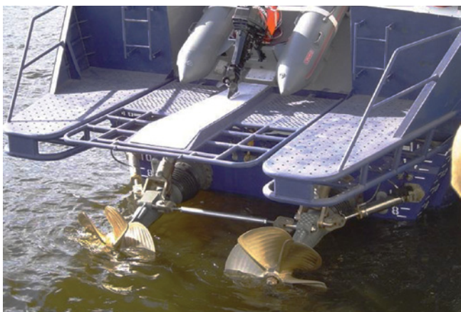
Рис. 2. Подъемно-поворотные приводы с частично-погружными гребными винтами в составе катера
