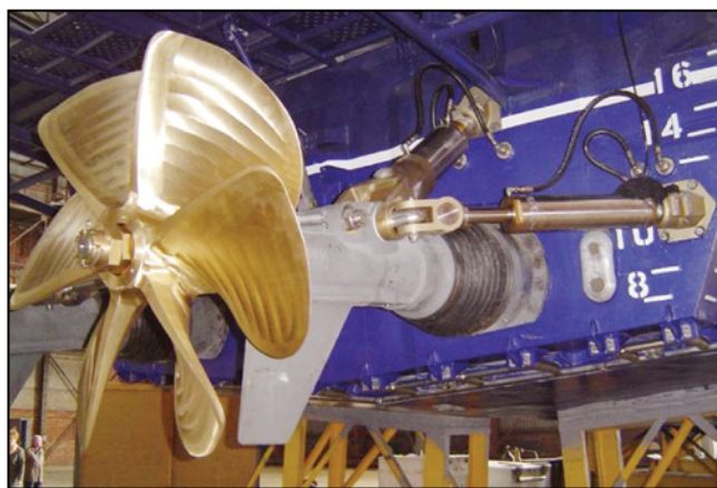
Рис. 2. Подъемно-поворотные приводы с частично-погружными гребными винтами в составе катера
