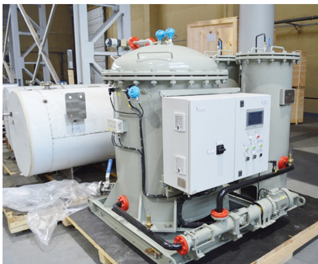
Установка для очистки нефтесодержащих вод СНЛВ-5,0
