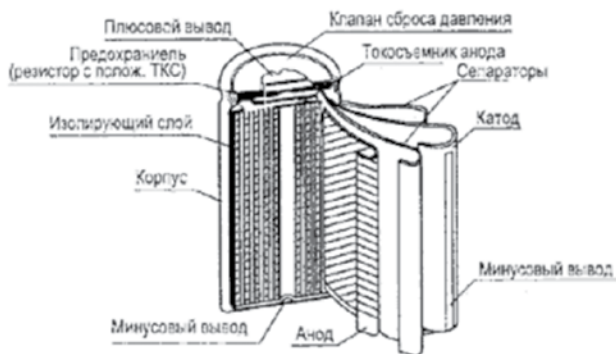
Рис. 3. Устройство литий-ионного аккумулятора цилиндрической конструкции
