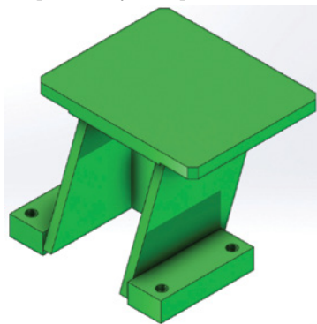
Рис. 4. Сварной кронштейн с классической сборкой
