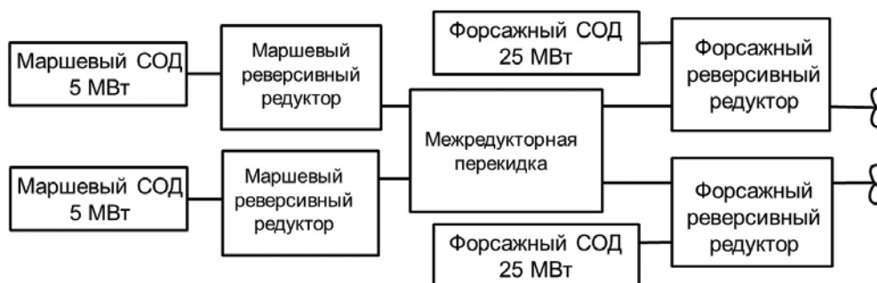
Рис. 1. Схематическое изображение агрегата КЭУ типа CODAD [3]
