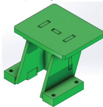
Рис. 5. Сварной кронштейн с применением соединений типа «шип-паз»
