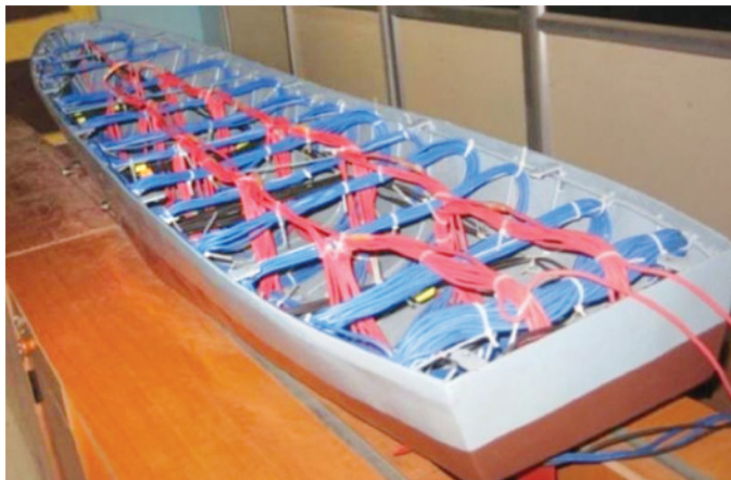
Рис. 3. Модель секционированных обмоток компенсации постоянных магнитных полей
