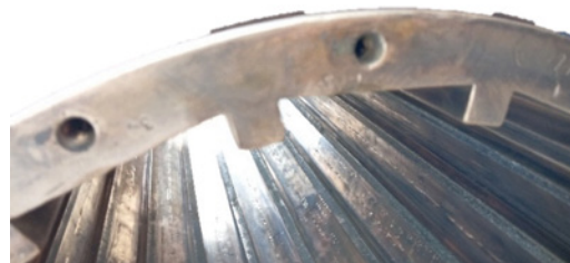
Рис. 2. Общий вид пазов «ласточкин хвост» (ОСТ 5.5154–74)
