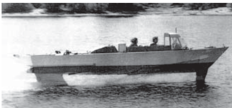
Рис.9. Модель КПК водоизмещением ок. 5 т с ВД
