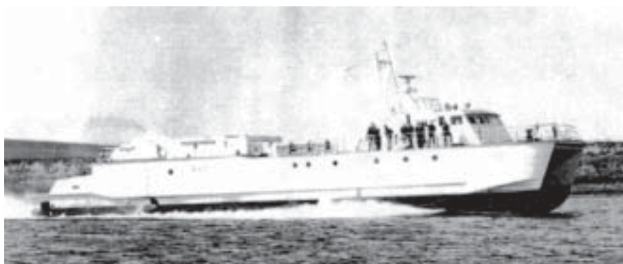
Рис.5. Опытный корабль водоизмещением 100 т с двумя ВД
