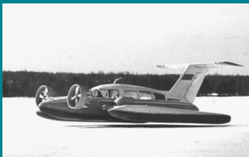
Рис.7. Речной пассажирский экраноплан «Волга-2»
