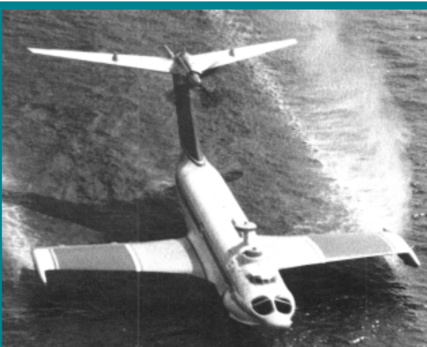
Рис.4. Транспортный экраноплан «Орленок»
