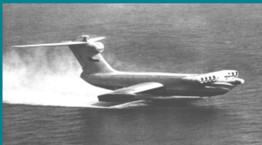
Рис.6. Поисково-спасательный экраноплан «Спасатель»
