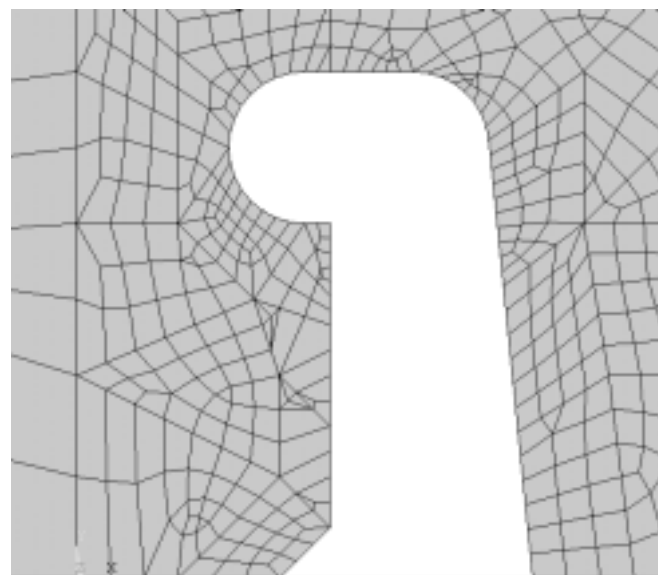
Рис.6. Фрагмент локальной расчетной модели стенки шпангоута в районе выреза для продольного ребра жесткости
