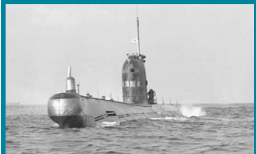
Рис. 2. Дизель-электрическая подводная лодка с поднятым ВУ
