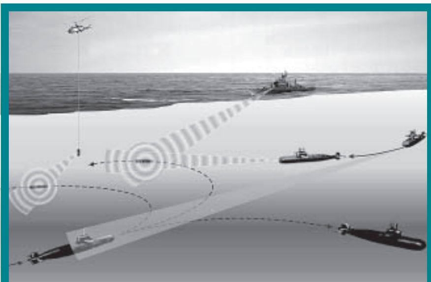
Схема боевого использования прибора МГ-74. Уклонение от обнаружения силами ПЛО
