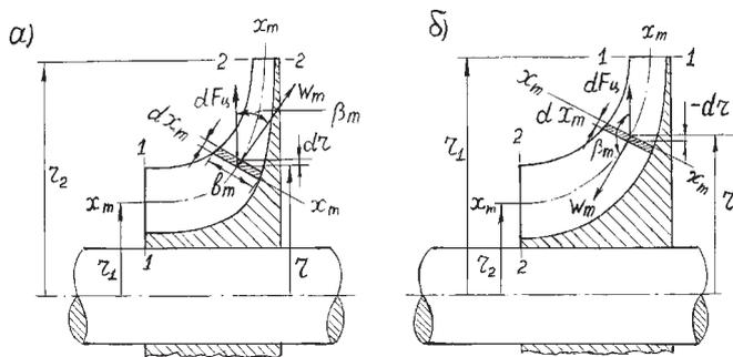
Рис.1. Схема меридионального сечения рабочего колеса радиальной (осерадиальной) турбомашин: а – осерадиального центробежного компрессора; б – радиально-осевой центробежной турбины.
