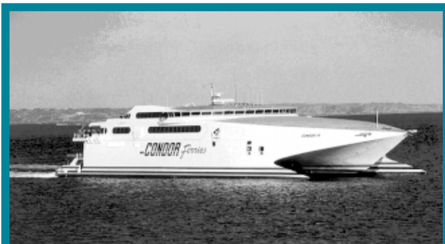
Рис.4. Волнопронзающий автомобильно-пассажирский паром «Condor» (WPC)
