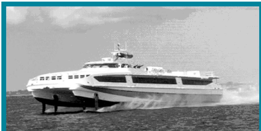
Рис. 2. Пассажирский катамаран с разгрузкой подводными крыльями «Linda Express» тина SF-40 (СКПК)
