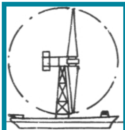
Рис. 6. Схема пропеллерного судна с лопастными ветроустройствами
