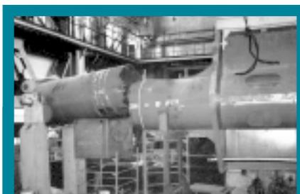
*Рис. 1. Ресурсные испытания крупногабаритной конструкции колонны буровой платформы до ее разрушения в эллинге ресурсных и статических испытаний*
