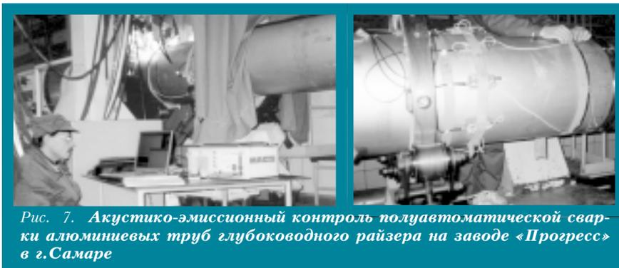
Рис. 7. Акустико-эмиссионный контроль полуавтоматической сварки алюминиевых труб глубоководного райзера на заводе «Прогресс» в г. Самаре
