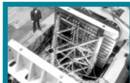
*Рис. 2. Статические испытания ферменной опорной колонны стационарной буровой платформы в испытательной машине МУГ-3000*
